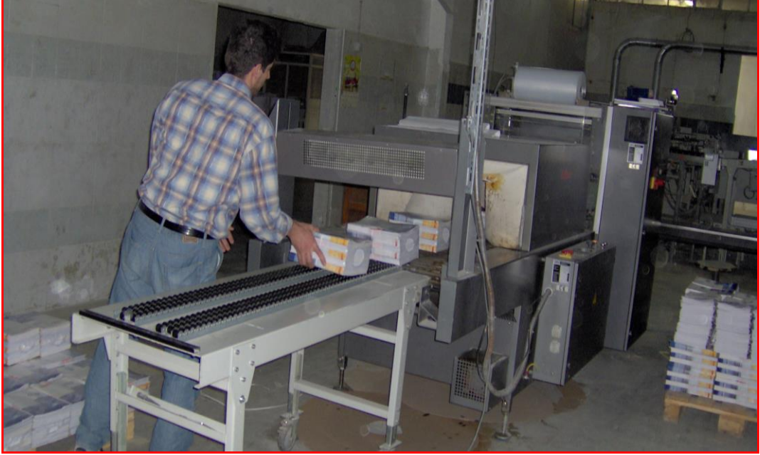
Şekil 1.4: Basılan ürünlerin folyololama (shrink) makinesine yerleştirilmesi
