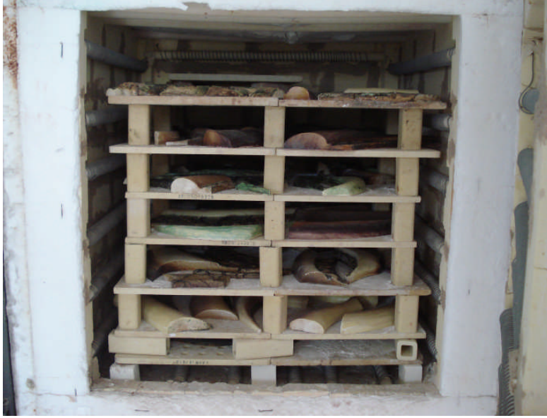
Resim 4.2: Sırlı pişirim yüklenmiş fırın
