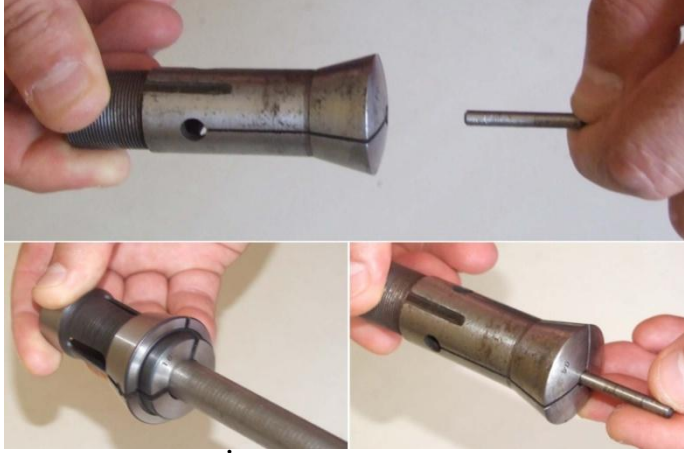
Şekil 1.8: İş parçasına uygun pens seçimi
