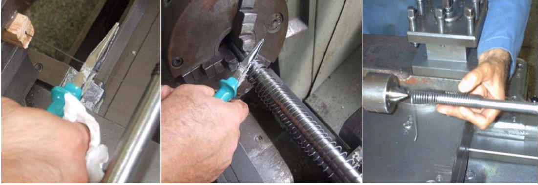
Şekil 2.14: Yay telinin kesilmesi ve malafadan çıkarılması
