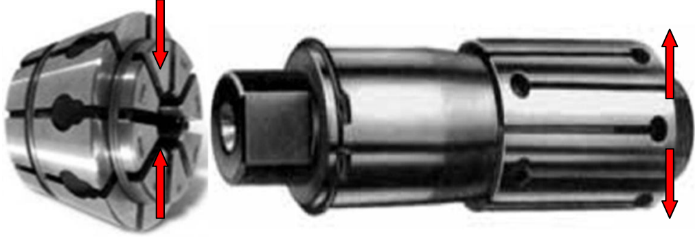
Şekil 1.4: Dıştan içe sıkmalı pens – içten dışa sıkmalı pens
