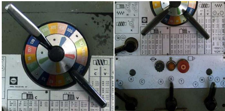
Şekil 2.9: Devir sayısı ve ana mili ilerleme miktarı kollarının konumlandırılması
