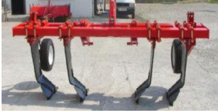
Resim 1.16: Toprağı derin işlemede kullanılan çok gövdeli dip kazan
