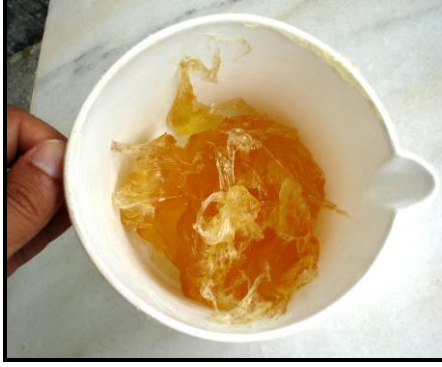
Resim.2.1: Arap sabununun jel hali
