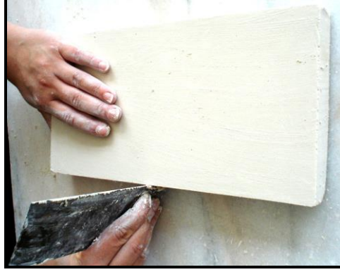
Resim 4.15: Sistire yardımı ile kenar düzeltme işlemi
