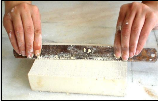
Resim4.11:Demir testeresi ile yüzeyi gönyeye getirme
