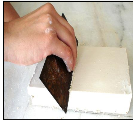
Resim4.7:Alçı plakasının sistire ile talaşlarının alınması
