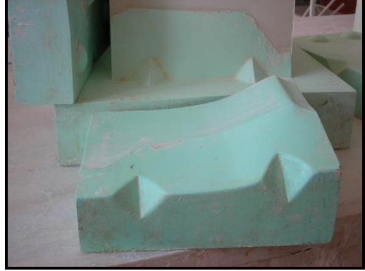
Resim 1.10:Teksir kalıpta köşeli pim uygulama Resim 1.11:Teksir kalıpta üçgen pim uygulama
