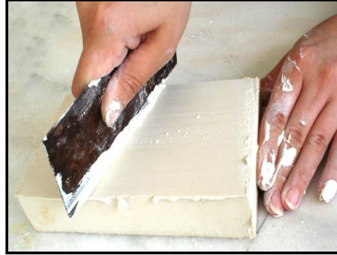
Resim4.10: Sistire ile yüzeyi düzeltme
