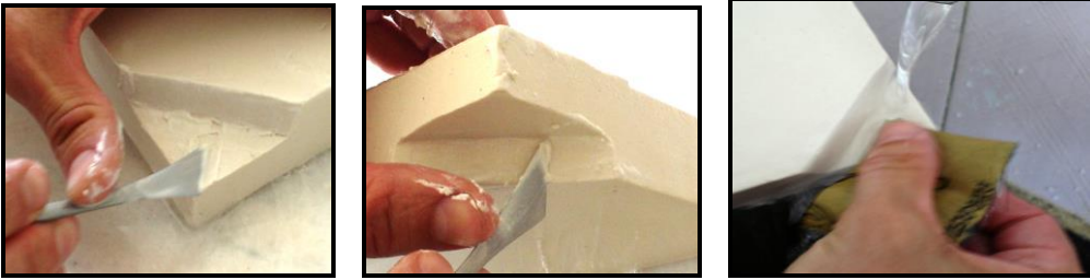
Resim5.7: Köşede üçgen pim açma aşamaları
