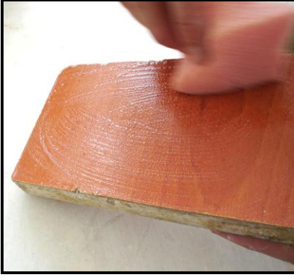
Resim.2.7: Arap sabunu ile yalıtma
