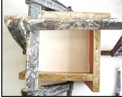
Resim2.11: İşkence ile (bağlayıcı) desteklenmiş kurgu
