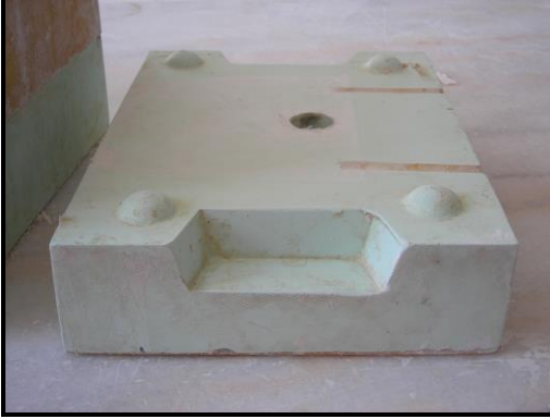
Resim 1.10:Teksir kalıpta köşeli pim uygulama Resim 1.11:Teksir kalıpta üçgen pim uygulama
