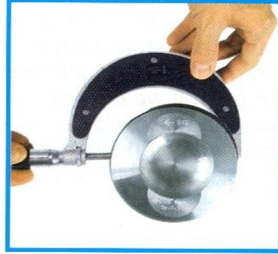
Resim 1.14: Pistonun mikrometre ile ölçülmesi
