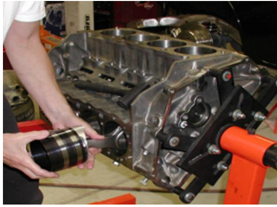
Resim 1.20: Pistonun silindir içerisine takılması
