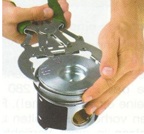
Resim 1.18: Segman pensesi ile segmanın pistondan çıkarılışı
