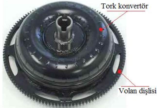
Resim 5.3: Tork konvertör üzerinde volan dişlisi
