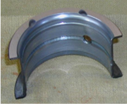
Resim 4.5: Kusinetli yatak yağ kanalları
