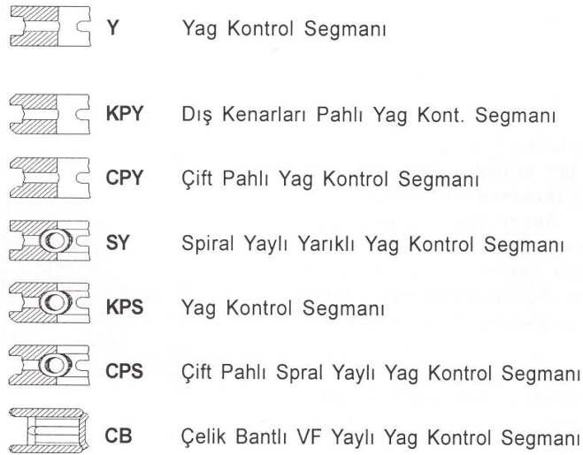
Şekil 1.33: Çeşitli yağ segmanı kesit görünüşleri
