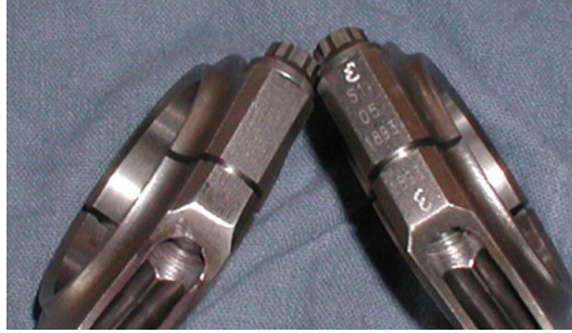
Resim 1.22: Biyel kepi üzerindeki işaretler
