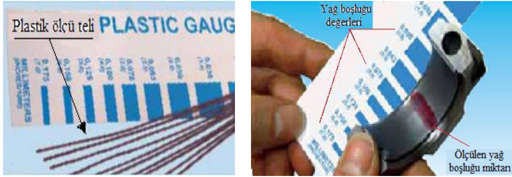
Resim 4.7: Plastik ölçü teli ile yağ boşluğu kontrolü
