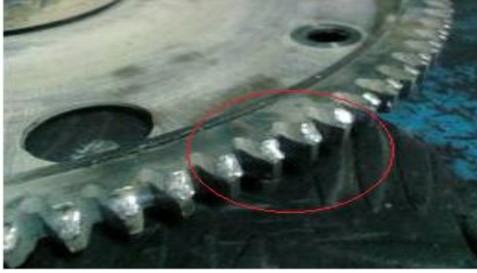
Resim 5.4: Aşınmış volan dişlileri
