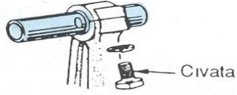
Şekil 1.39: Pim, biyelde sabit, pistonda serbest
