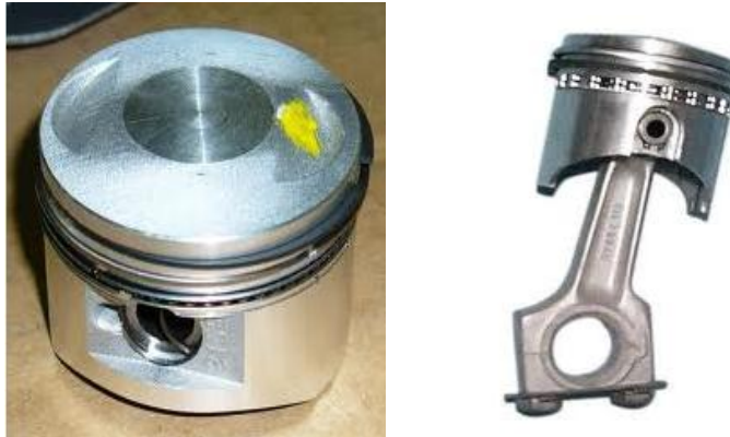
Resim 1.17: Segmanların pistona takılmış hâli
