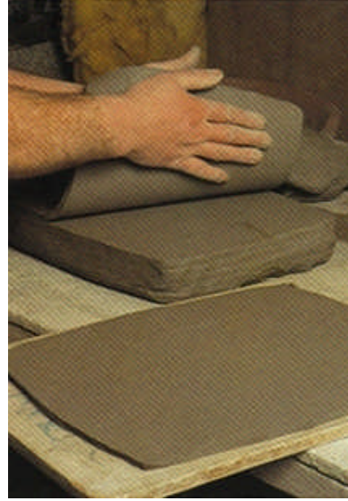
Resim 1. 3: Kesilen plakaların ayrılması
