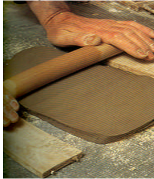
Resim 1. 1: Merdane ile plaka açma
