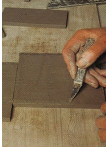
Resim 1.6:Yapıştırma yapılacak yerlerin Çentiklenmesi
