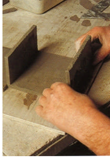
Resim 1.8:Üçüncü parçanın birleştirilmesi
