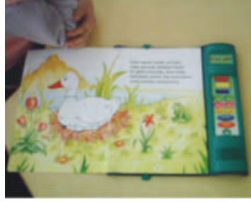
Resim1.31:Konuşan kitap. Kitabın yerleştirildiği mekanızma'başlat' düğmelerine dokunarak öğrenciye sorular sorulur. Öğrenci konuşan kitabın sorularına cevaplar verir ya da istenilen kelimeleri gösterir. Doğru yanıtlar ve seçenekler kitaptan gelen alkış sesiyle ödüllendirir
