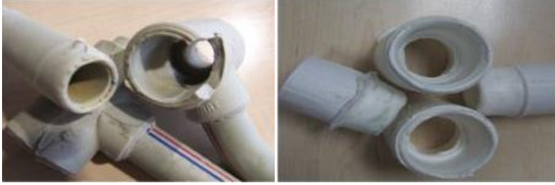
Resim 2.14: Kaynak makinesi pafta sıcaklığının yetersiz olduğu birleştirmeler
