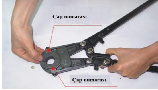
Resim 4.8: Takılacak çene üzerinde çapın yazılması
