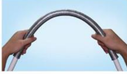
Resim 4.16: Boruyu yay içerisine yerleştirerek bükme
