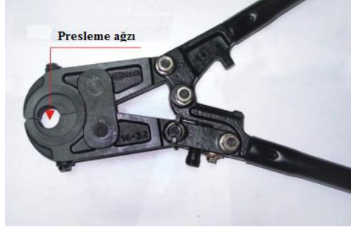
Resim 4.9: Çenenin orta boşluktaki tırnaklarının preslemeyi sağlaması
