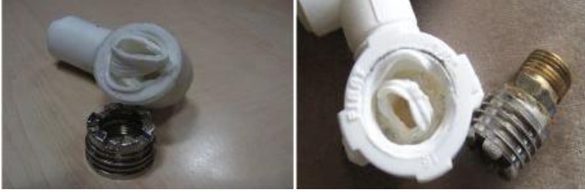
Resim 2.15: Aşırı basınç ve aşırı sıcaklığa uğramış parçalar
