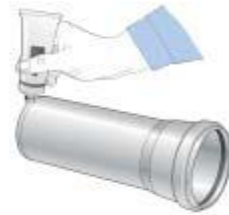
Şekil 5.5: Boru yumuşak iken mufunun yapılması Resim 5.15: Yapıştırıcının sürülmesi
