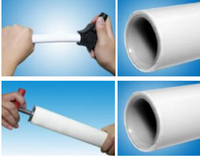
Resim 4.11: Kılavuz boru ağızını düzgün bir şekilde düzlememizi ve genişletmemizi sağlar.
