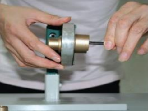
Boru çapına uygun kaynak paftası sıkılır.
