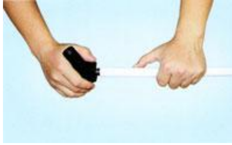
Resim 4.30: Bir boru kılavuzu ile borunun ağzının düzeltilip konikleştirilmesi
