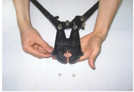
Resim 4.7: Boru pres aletine uygun çene takılması
