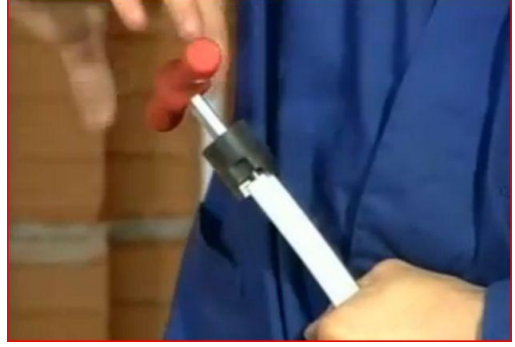
Resim 4.40: Ölçü alınıp boru kesilmesi
