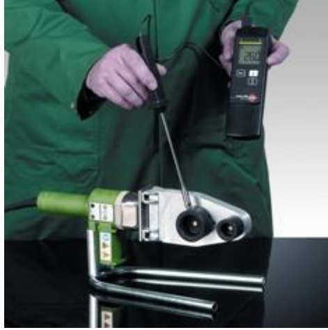
Resim 1.5:Füzyon kaynak makinesi pafta sıcaklığı ölçümü
