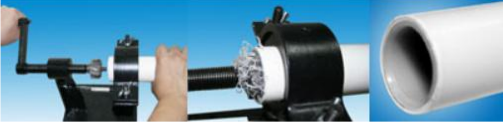
Resim 4.67: Kalıpta boru ağzının raybalanması
