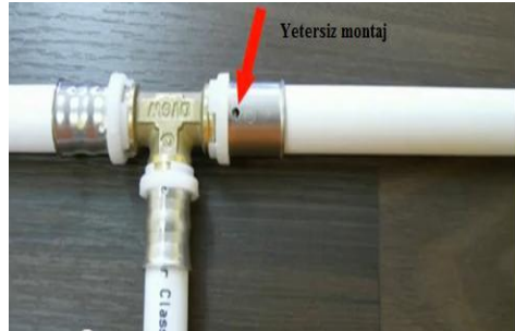
Resim 4.53: Birleştirme parçasının oturtulması (yanlış bağlantı)
