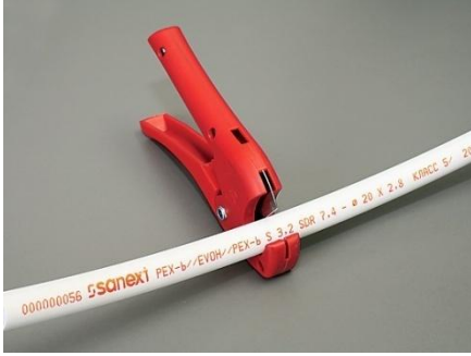
Resim 4.23: Kesme işleminin yapılması
