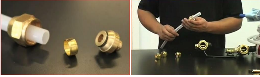
Resim 3.35: Rakorun boruya yerleştirilmesi
