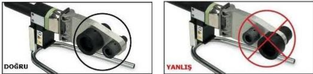
Resim 2.3: Füzyon kaynak makinesine paftaların doğru ve yanlış bağlantıları
