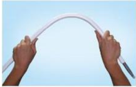
Resim 4.15: Yayı boru içerisine yerleştirerek bükme
