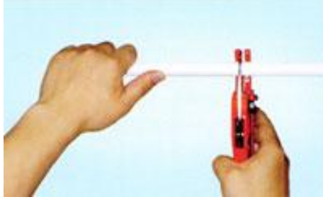
Resim 4.29: Bir boru makası kullanılarak doğru açılı boru kesilmesi
