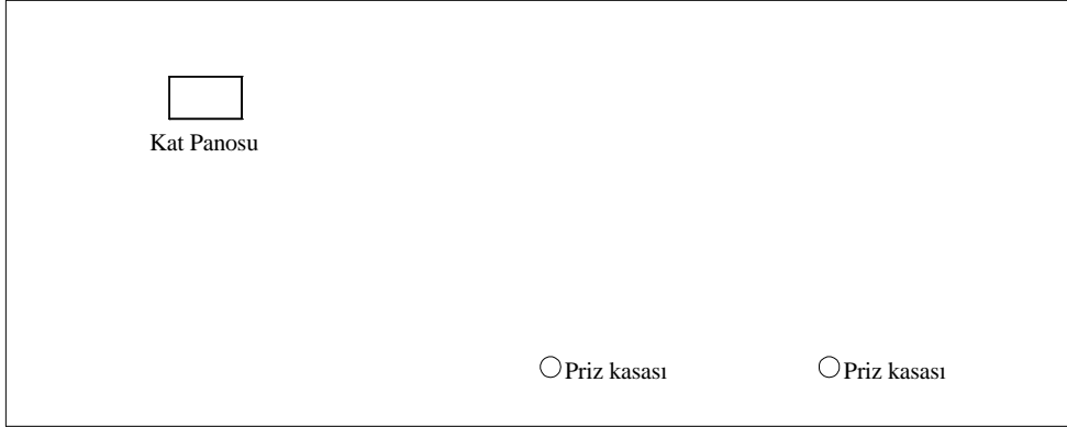
Şekil 3.1: Kat panosu ve prizlerin yerinin tespit edilmesi
