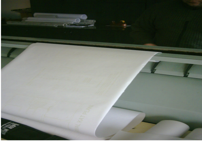
Resim 1.6: Ozalit kâğıdının makineden çıkışı
