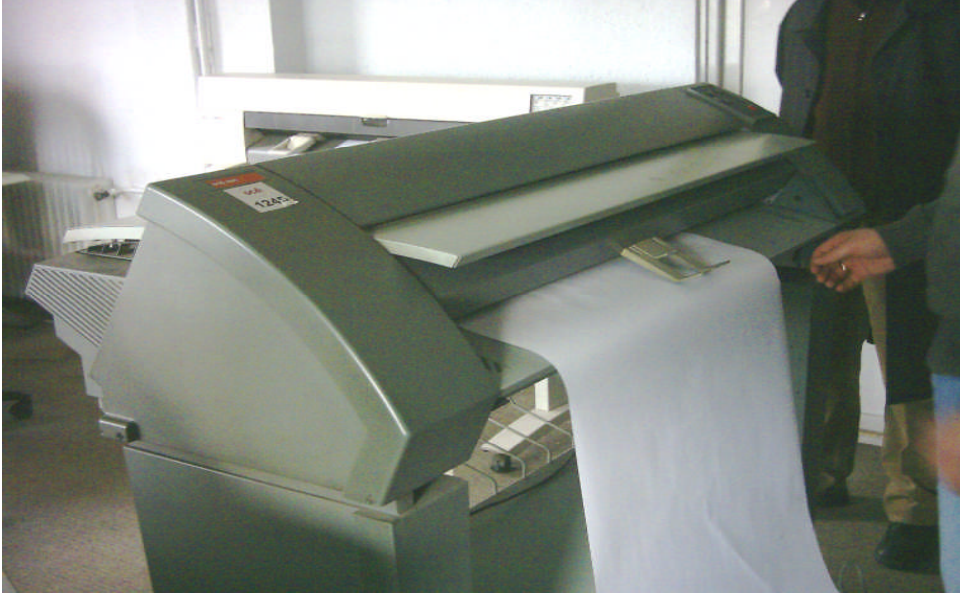
Resim 1.10: Kopya kâğıdının makineye verilmesi
