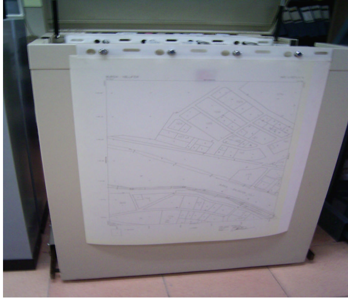
Resim 3.15: Askı kartları ile paftaların dolap askularına takılması
