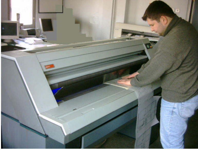
Resim 1.4: Ozalit makinesine aydınlar ve ozalit kâğıdının birlikte verilmesi
