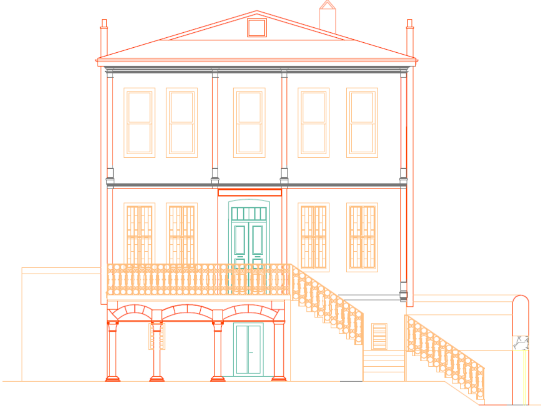
Çizim 3.11: Çatı eğimi, şekli ve bacaların çizilmesi
