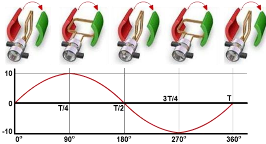
Şekil 2.3: Manyetik alan içinde hareket eden iletken
