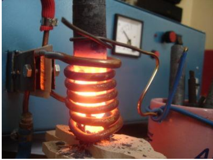
Resim 2.4: İndüksiyon fırınıyla ısıtma
