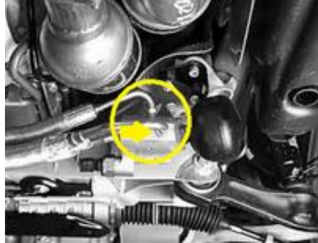
Resim 4.25: Basınç besleme valf grubu
