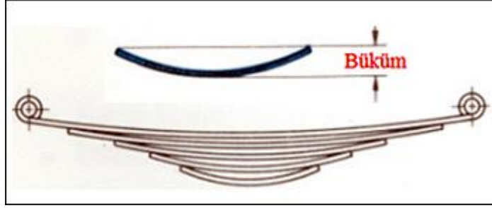
Şekil 2.3: Yaprak yay bükümleri
