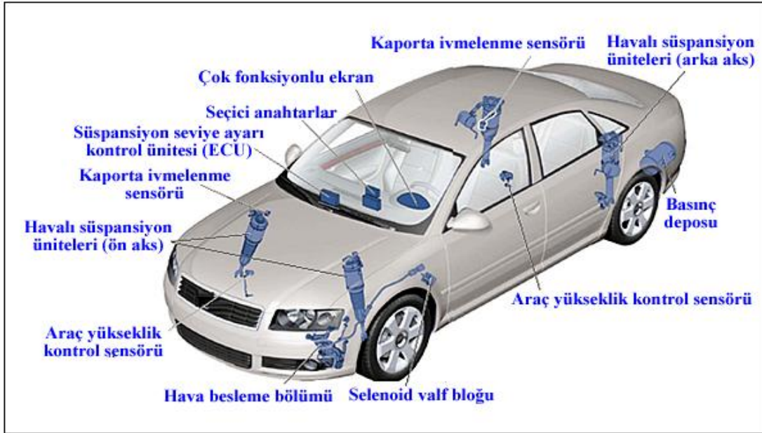
Şekil 4.1: Aktif (elektronik kontrollü) süspansiyon sisteminin araç üzerindeki yerleri
