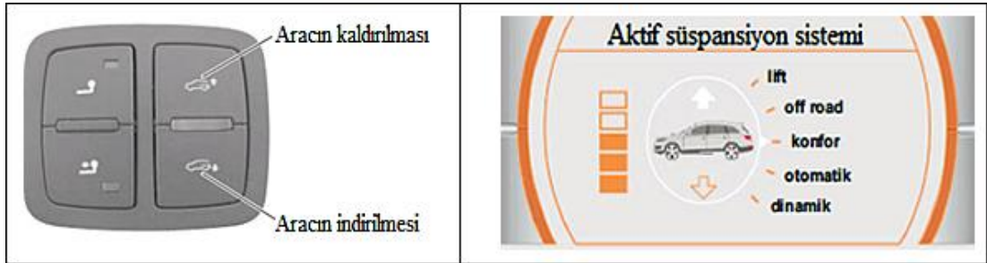
Resim 4.13: Seçici anahtarlar ve çok fonksiyonlu ekran
