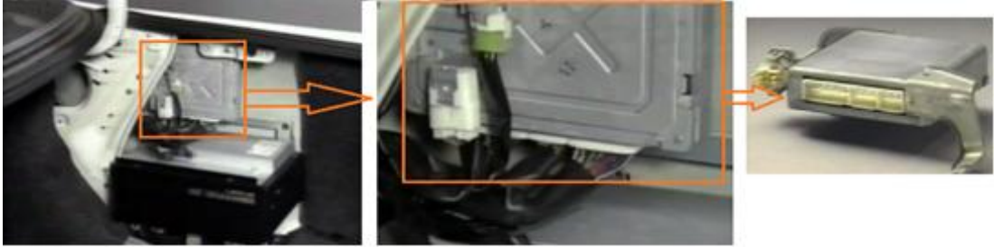
Resim 4.3: Bagaj bölümünde yer alan süspansiyon seviye ayarı kontrol ünitesi (ECU)
