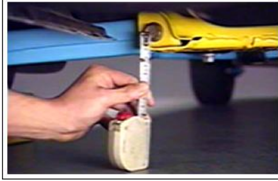
Resim 2.6: Araç yüksekliğinin ölçülmesi
