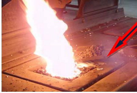
Şekil 1.22: Kömürün ilave edilmesi
