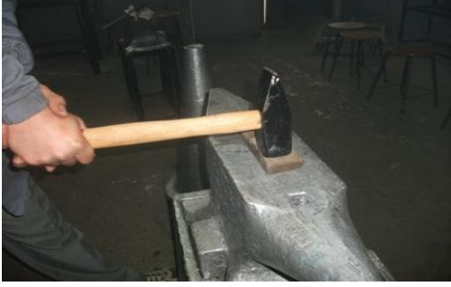
Resim 3.15:Çekicinin istenilen noktaya vurulması
