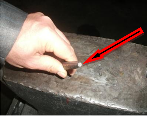
Resim 7.10: Eksen izinin kontrolü
