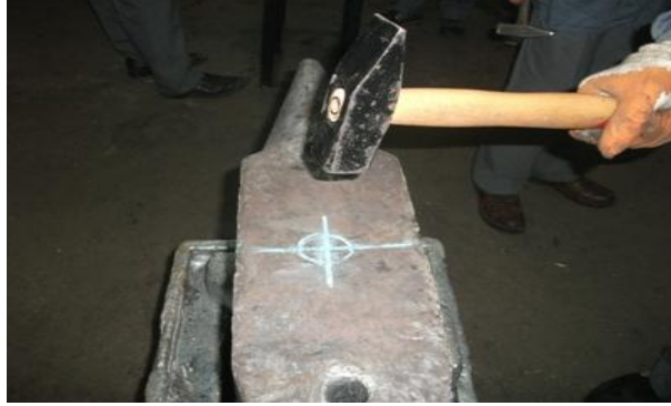
Resim 3.8:Çekici vurulması gereken yere yönlendirme
