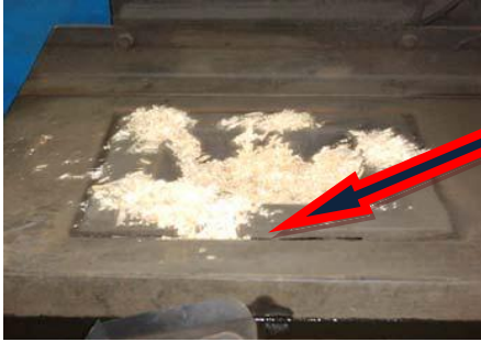
Şekil 1.17: Talaşın etrafa dağılması
