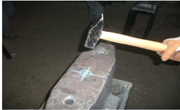
Resim 3.7: Çekici vurulması gereken yere yönlendirme
