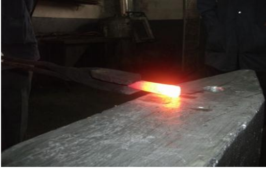
Resim 2.11: Dövme tava rengindeki parça
