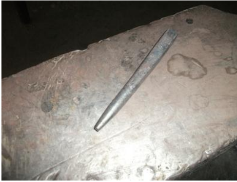
Resim 7.11: Eksen doğrultusu kontrol edilen bitmiş koni
