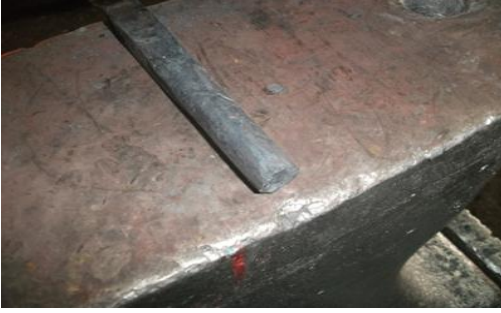
Resim 6.7: Köşelerinden dövülmüş parça
