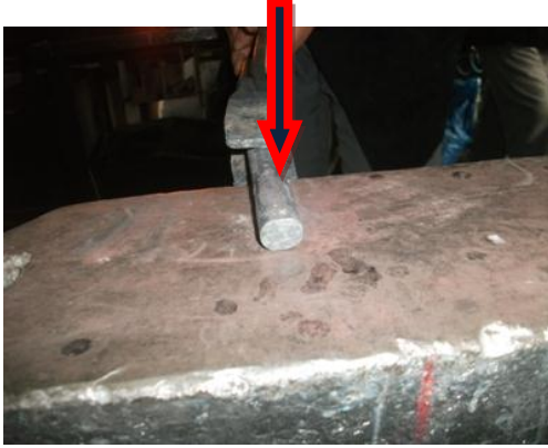
Resim 3.4: 1 ve 2. yüzey çekme işlemi
