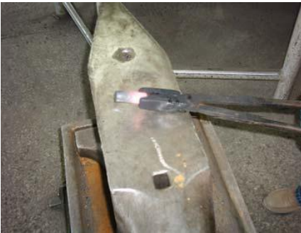
Resim 2.7: Homojen olmayan tavlama
