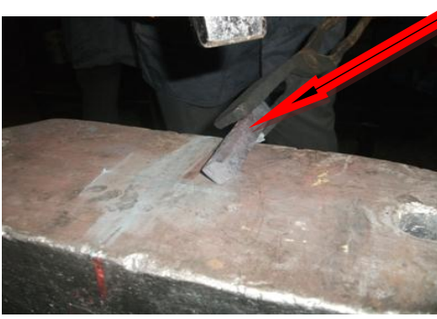
Resim 6.5: Köşeden yüzey sayısını artırma
