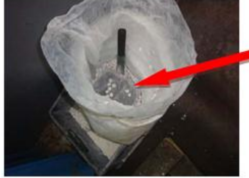
Resim 1.9: Tuz banyolarında kullanılan tuz esaslı bileşik
