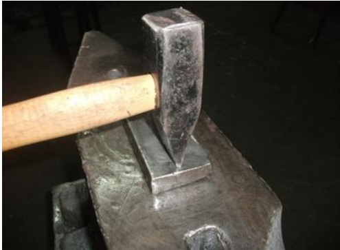
Resim 3.16:Sivri uç ile takozu dövme
