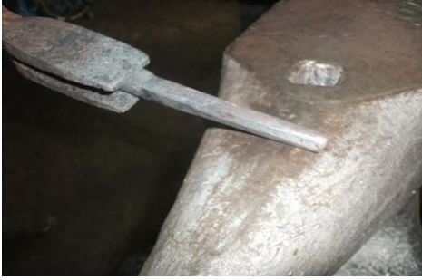
Resim 7.8: İşlenen kısmın koni hâline getirilmesi
