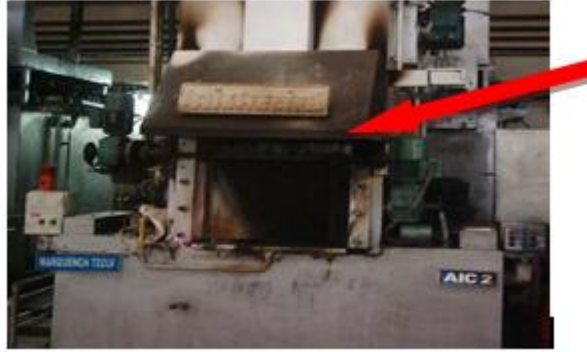
Resim 1.5: Yakıtlı tav fırını
