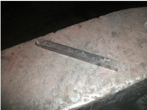
Resim 4.10: Kare çekilmiş parça
