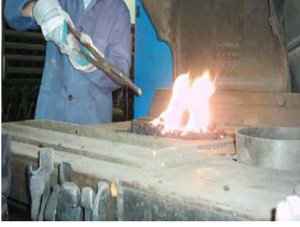
Resim 2.5: Parçayı ocağa eğik yerleştirmek
