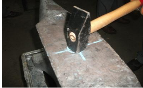
Resim 3.9: Çekici vurulması gereken yere yönlendirme
