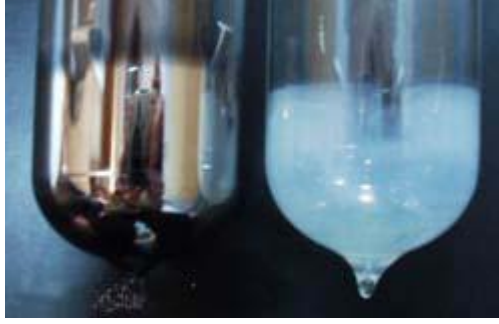
Resim 3.8: Doęru Vakumlama (sol yandaki), baŐarısız bir vakumlama (saę yandaki)
