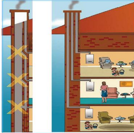
Resim 1.21: Şofben baca bağlantıları
