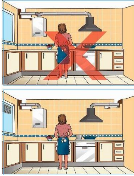
Resim 1.22: Şofben doğru yanlış bağlantıları
