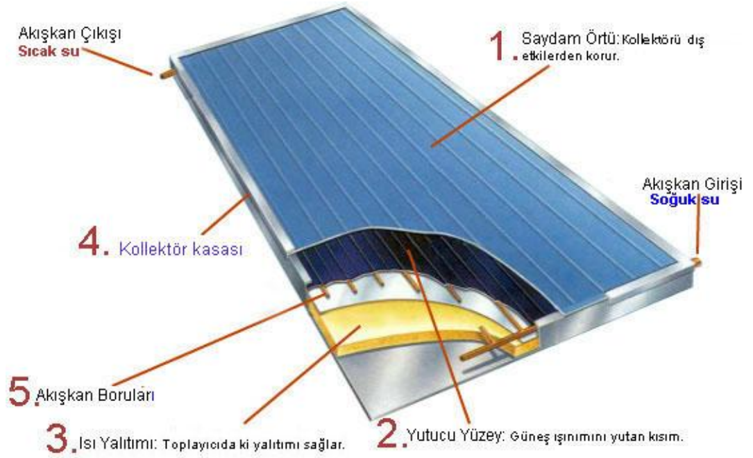
Şekil 3.4:Kollektör kesiti
