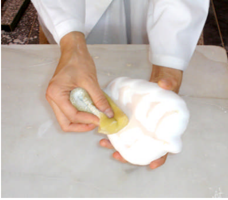
Resim 1.7: Fırın plakasına değen yerlerin sırların silinmesi
