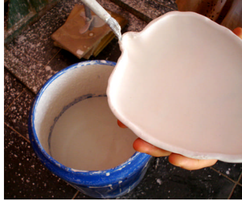
Resim 4.3: Sırsız yerlerin fırça ile sırlanması
