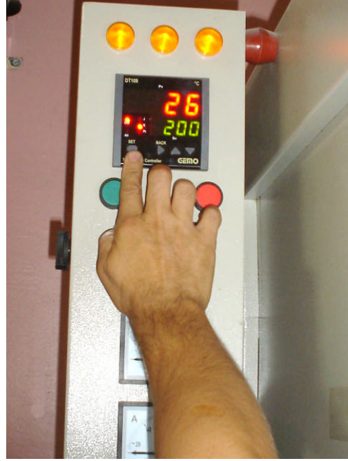
Resim 5.3: Fırın sıcaklık ayarlarının yapılması
