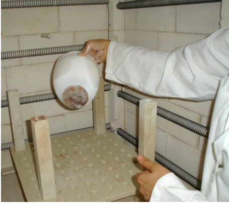
Resim 5.1: Sırlı ürünlerin altının kontrolü
