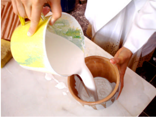
Resim 1.3: Bisküvinin içine sır doldurulması Resim 1.4: Bisküvinin içinden sırnın boşaltılması
