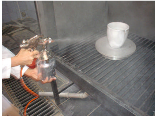
Resim 2.2: Püskürtme yöntemi ile sırlama
