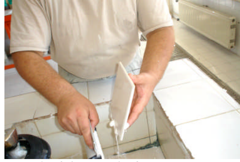
Resim 3.4: Ragle ile fayansın sırlanması
