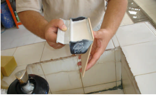
Resim 3.3: Ragle ile fayansın sırlanması
