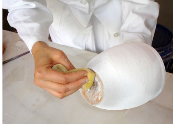
Resim 2.4: Ürünün altının silinmesi
