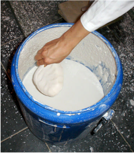
Resim 1.1: Bisküvinin sır içine daldırılması Resim 1.2: Bisküvinin sır içinden çıkarılması
