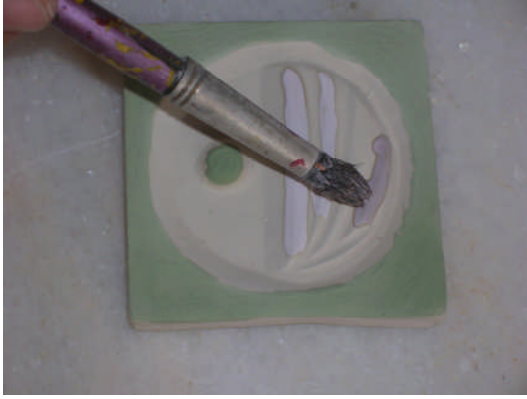
Resim 4.1: Fırça ile sırlama aşamaları
