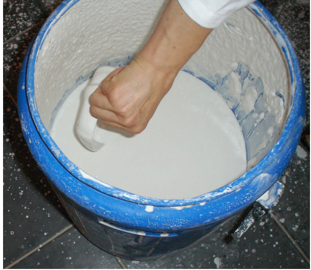
Resim 1.1: Bisküvinin sır içine daldırılması Resim 1.2: Bisküvinin sır içinden çıkarılması
