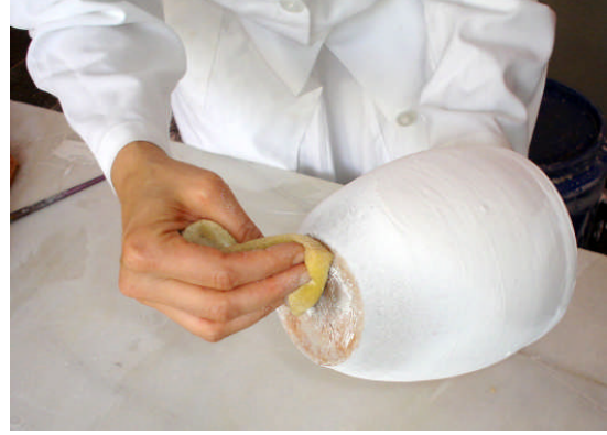
Resim 1.7: Fırın plakasına değen yerlerin sırların silinmesi
