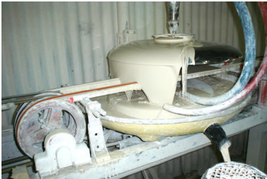
Resim 3.1: Kampana ile fayansın sırlanması
