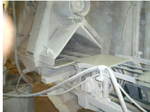
Resim 3.2: Disk ile fayansın sırlanması
