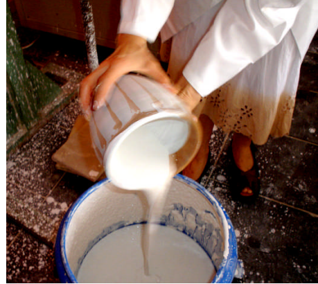
Resim 1.3: Bisküvinin içine sır doldurulması Resim 1.4: Bisküvinin içinden sırnın boşaltılması
