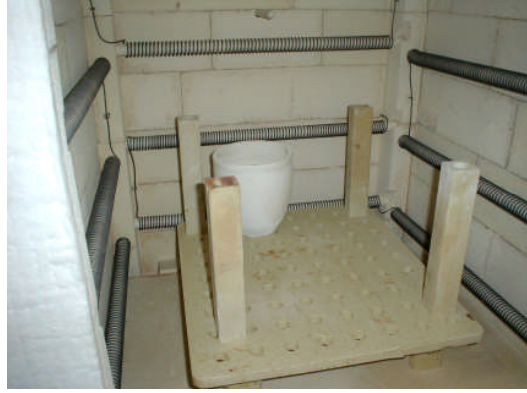
Resim 5. 2: Sırlı ürünlerin fırına yerleştirilmesi
