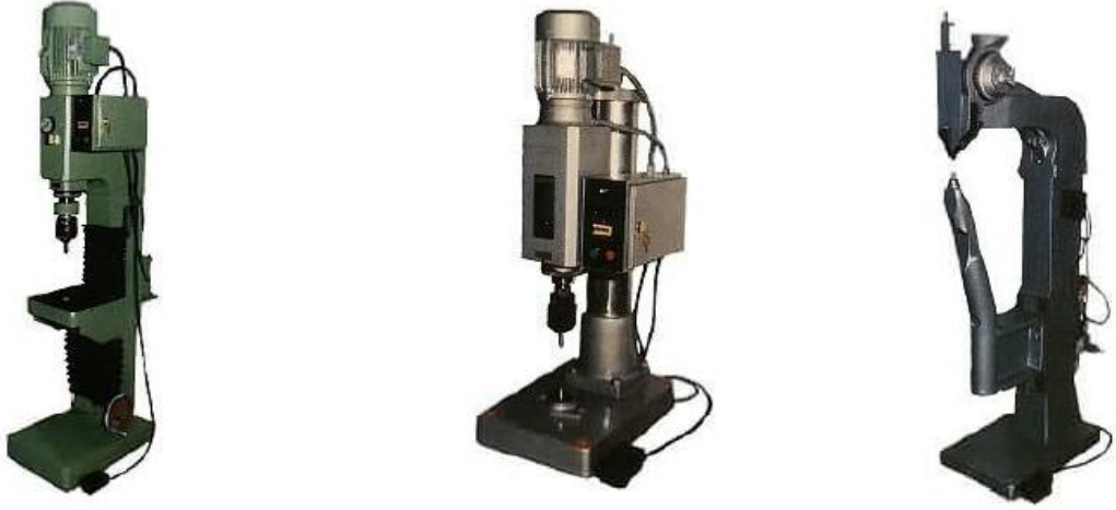
Resim 2.10: Sütun tipi tasarımlı otomatik elektro-hidroprömatik kumandalı perçinleme makineleri
