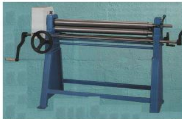
Resim 3.11: Sac ve yassı gereçlerin büküldüğü silindir makineleri
