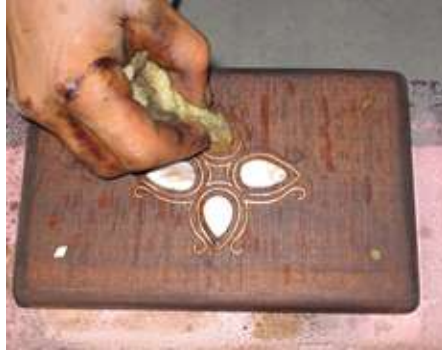
Resim 2.13: Sedef üzerindeki boyanın silinmesi
