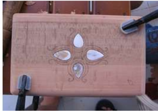
Resim 2.3: Sedef yuvalarının oyulması ve sedeflerin yerlerine alıştırılması
