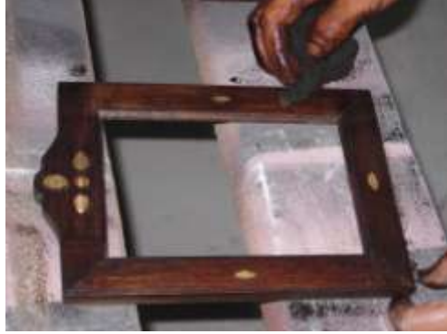
Resim 3.12: Çerçeveye Osmanlı eskitme sürülmesi
