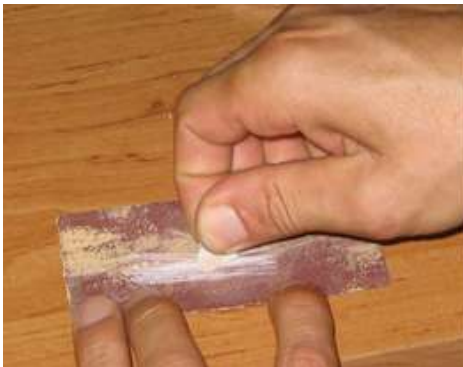
Resim 1.16: Zımpara kâğıdı kullanılarak sedefin şekillendirilmesi
