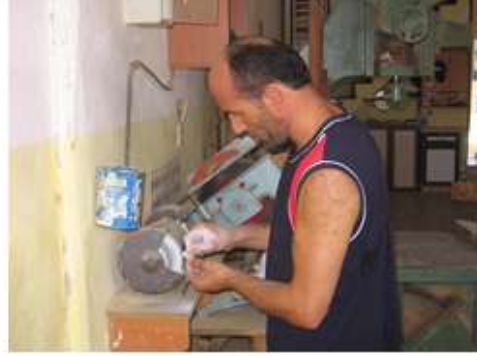
Resim 1.14: Sedef parçalarının zımpara taşı kullanılarak şekillendirilmesi
