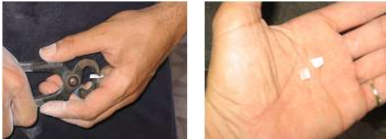
Resim 3.4: Sedefin kerpeten ile kesilmesi
