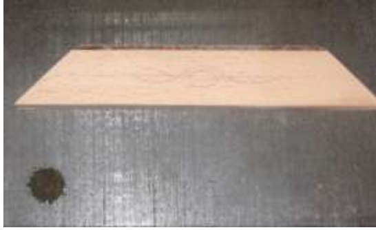
Resim 3.2: Aslına uygun ölçüde hazırlanmış alt kayıt
