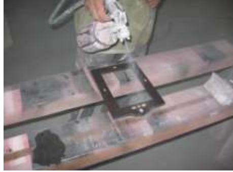
Resim 3.16: Çerçeveye mat vernik uygulaması
