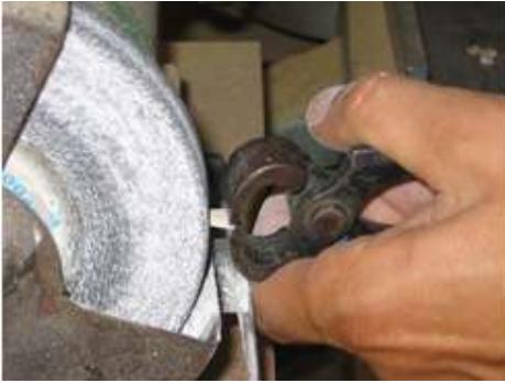
Resim 1.15: Zımpara taşında şekillendirilmiş sedef parçaları
