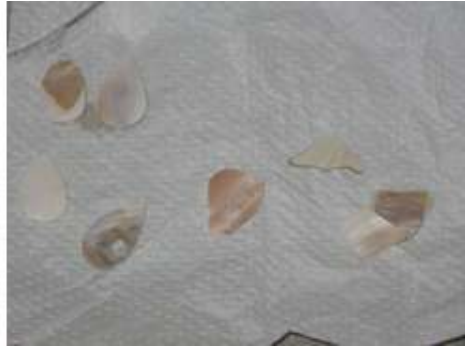
Resim 1.15: Zımpara taşında şekillendirilmiş sedef parçaları
