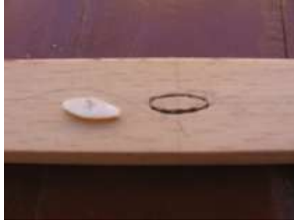
Resim 3.6: Motif çizgilerinin kesilmesi
