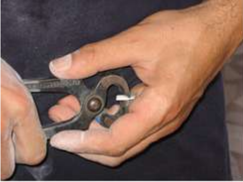
Resim 1.13: Sedef parçalarının kerpeten ile kesilmesi
