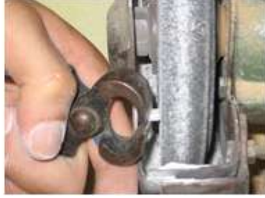
Resim 3.5: Sedefin zımpara taşında şekillendirilmesi
