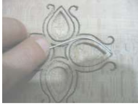
Resim 2.5: Telin tel yuvasına yerleştirilmesi
