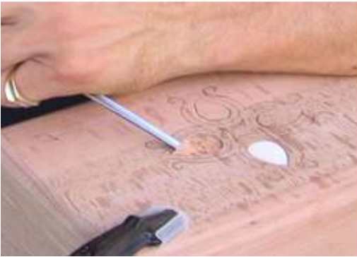
Resim 2.3: Sedef yuvalarının oyulması ve sedeflerin yerlerine alıştırılması
