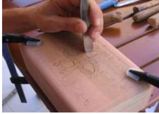
Resim 2.2: Motif hatlarının kesilmesi
