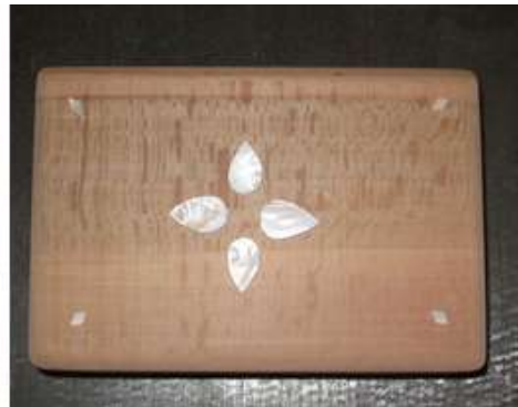
Resim 1.16: Zımpara kâğıdı kullanılarak sedefin şekillendirilmesi
