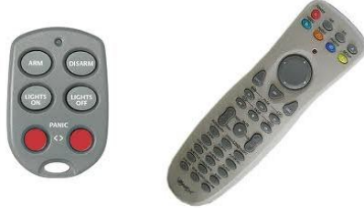
Resim 4.1: İnfiraruj LED kullanılan uzaktan kumandalar
