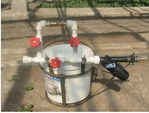
Resim 2.28: Küçük seralar için filtre ve gübreleme sistemi
