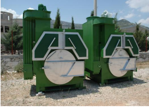
Resim 2.8: Sera ısıtmasında kullanılan kalorifer kazaları
