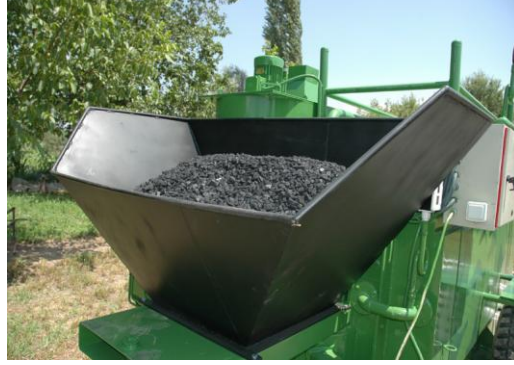
Resim 2.9: Kömür yakan kalorifer kazanı deposu
