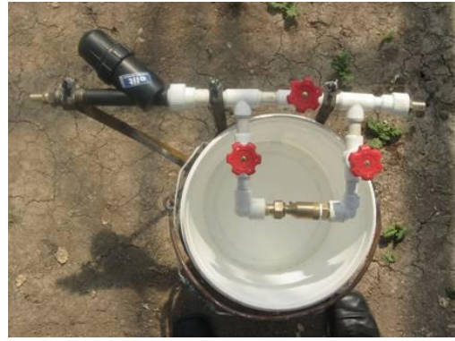
Resim 2.28: Küçük seralar için filtre ve gübreleme sistemi
