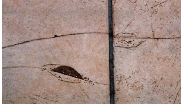
Resim 1. 14: Raf ömründen kaynaklanan hata
