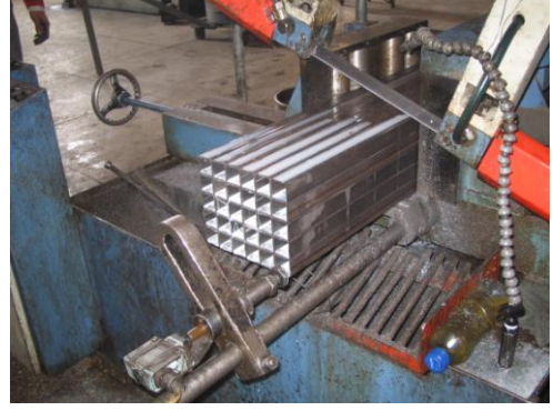
Resim 1.9: Şerit testere için tasarlanmış dayama kalıbı
