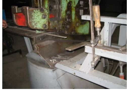
Resim 1.11: İş parçasını işkence ile profil üzerine bağlanan parçaya yaklaştırılması
