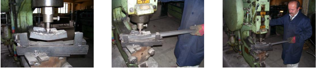
Resim 1.14 : Bükme kalıbı kullanılarak iş parçasının bükülmesi
