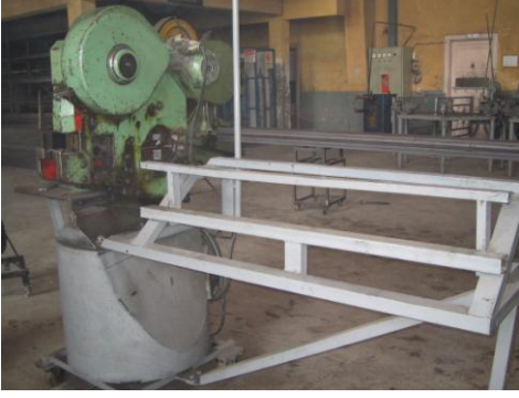
Resim 1.8: Profil makas için tasarlanmış dayama kalıbı
