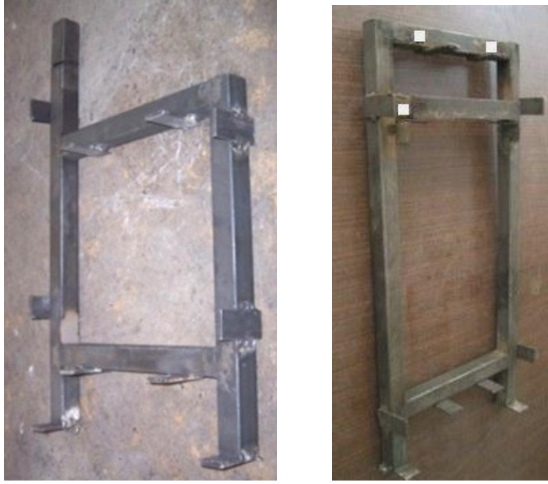
Resim 2.1: Öğrenci okul sırası montaj kalıbı
