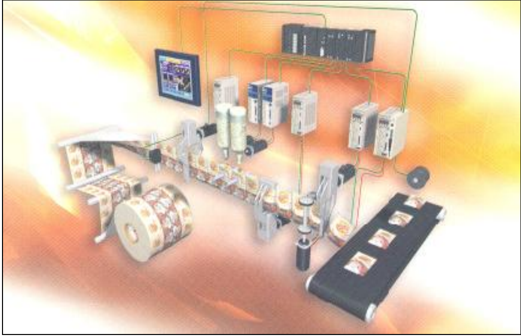
Şekil 4.3: Sarıcı ve besleyici taşıyıcının bulunduğu servo sistem
