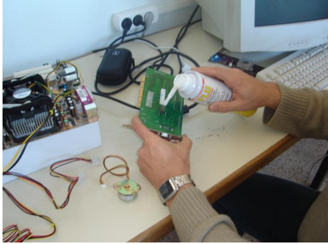
Resim 2.14: Temizleme spreyi ile temizleme
