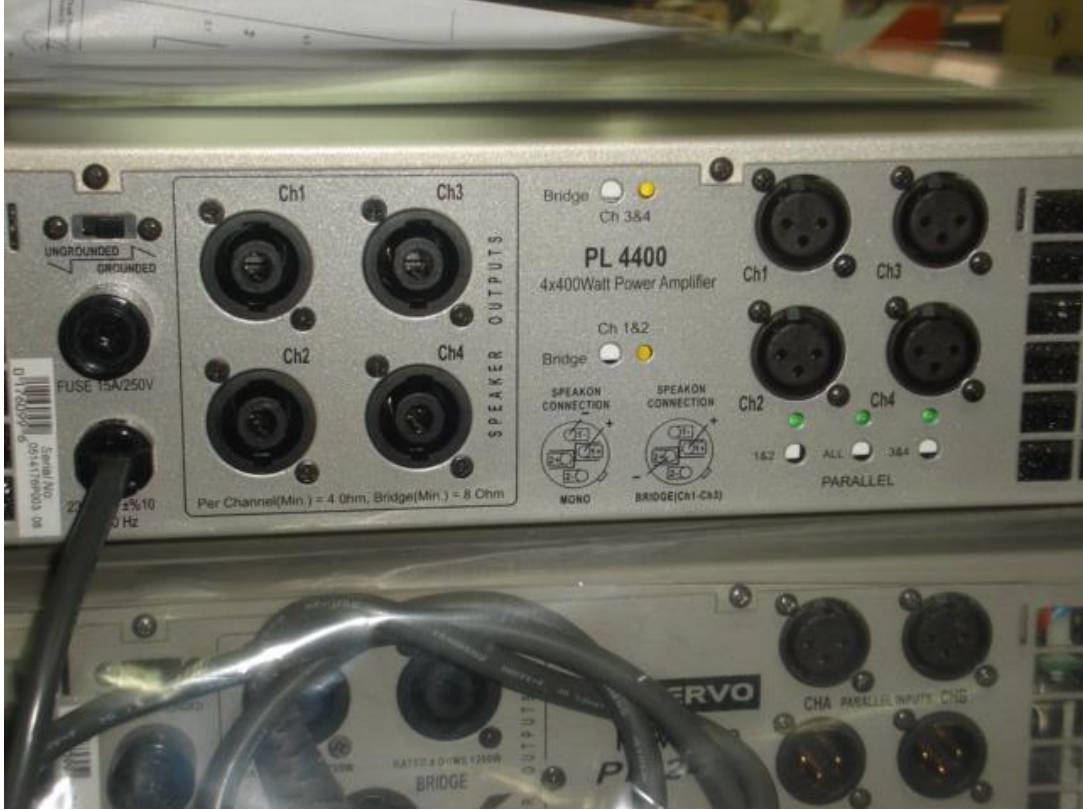
Resim 2.2: Amplifikatöre ait giriş çıkışlar
