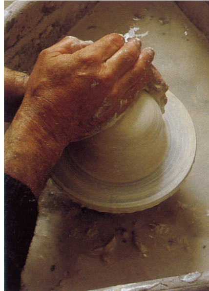
Resim 1.7 :Dış yüzeyini silindirik haline getirme
