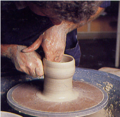
Resim 1.10: Silindirin ellerle yükseltilmesi
