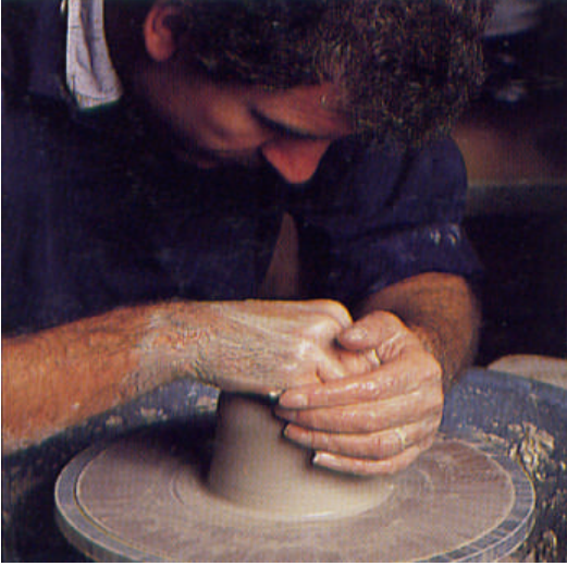
Resim 1.8: Silindir oluşturma işlemi
