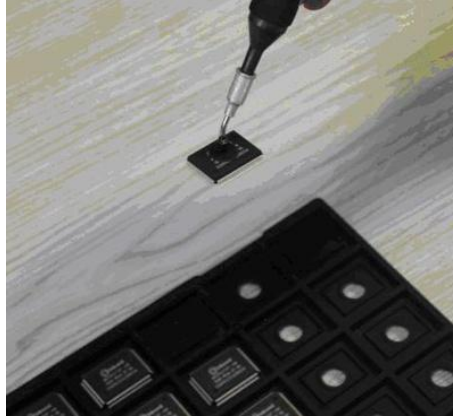
Resim 3.6: Çipsetin vakumlu havaya ile taşınması
