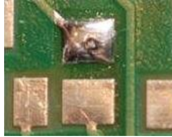
Resim 1.7: PAD (bakır nokta)
