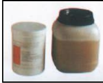
Resim 1. 7: Gümüş kaynak tozu borax ve alüminyum dekapanı
