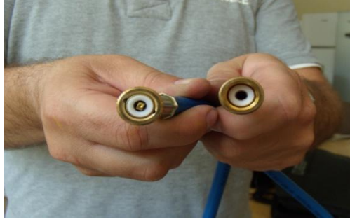
Resim 2.9: Gaz hortumlarının iğneli ve iğnesiz görünümü
