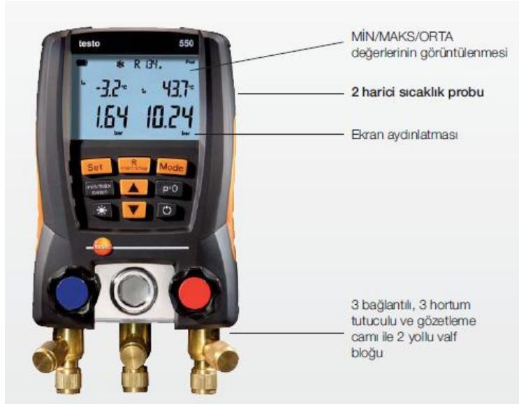
Resim 2.3:Dijital gaz manifoldu
