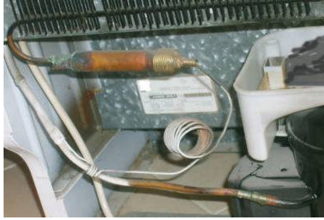
Resim 4.5: Drayerin monte edilmiş şekli
