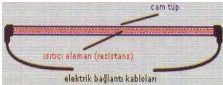
Resim 4.11: Defrost rezistansı elektrik kabloları
