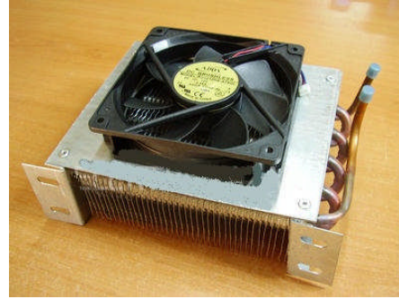
Şekil 2.5: Fan takılmış kondenser
