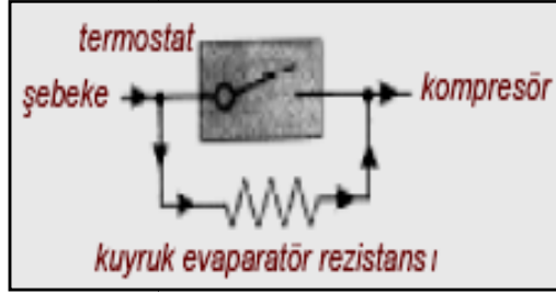
Şekil 3.4: Evaporatör rezistansı
