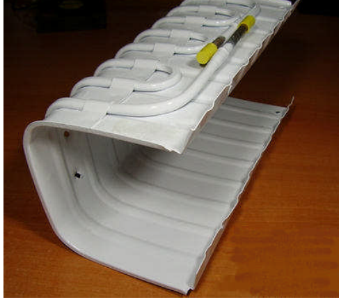
Resim 3.2: Buzluk ölçülerine göre şekillendirilmiş buzdolabı evaporatörü
