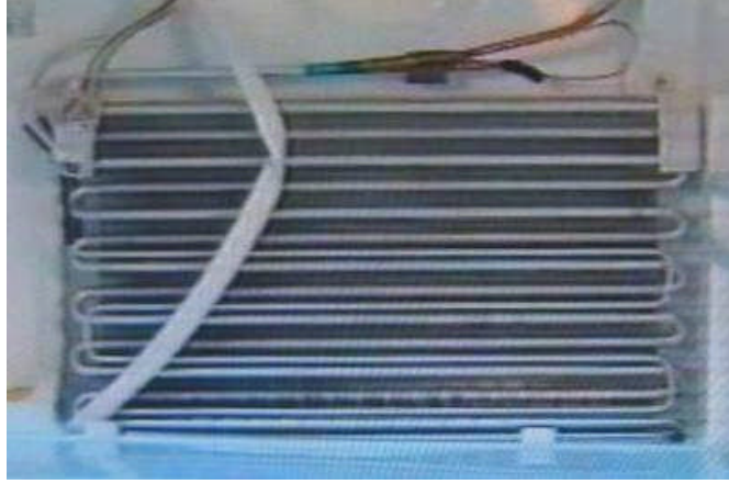
Resim 4.12: Defrost rezistansı elektrik bağlantı kabloları
