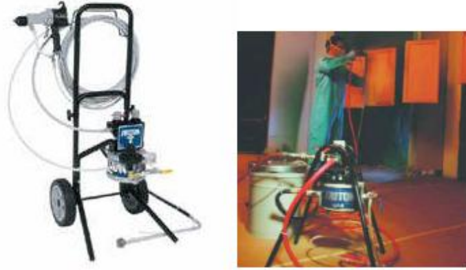
Resim 4.2: Çift hortumlu püskürtme tabancası ve kullanılması
