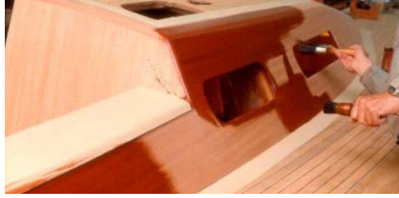
Resim 2.1: Fırça ile deniz aracına ve bina dışına vernik uygulama
