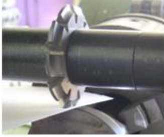
Resim 3.17: Modül çakısının kâğıt kullanarak taslağa teğet hâle getirilmesi ve mikrometrik bileziğin sıfırlanması
