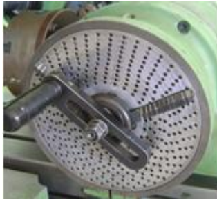
Resim 3.18: Divizör makas ayarının yapılıp zincir dişli çarkın açılarak tamamlanması
