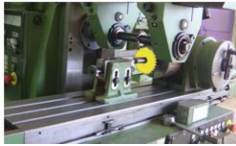
Resim 3.18: Divizör makas ayarının yapılıp zincir dişli çarkın açılarak tamamlanması
