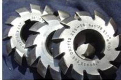
Resim 3.15: Zincir dişli modül çakısı ve üçlü takımı
