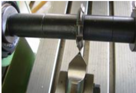
Resim1.16: Dişli taslağı ve modül freze çakısının sabit punta ile eksen ayarının yapılması
