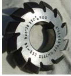
Resim 3.15: Zincir dişli modül çakısı ve üçlü takımı
