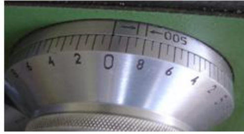
Resim 3.17: Modül çakısının kâğıt kullanarak taslağa teğet hâle getirilmesi ve mikrometrik bileziğin sıfırlanması
