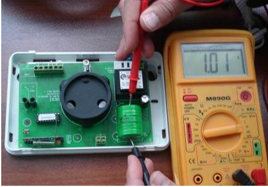
Şekil 1.7: Soygun alarm sisteminde gerilim ölçmek
