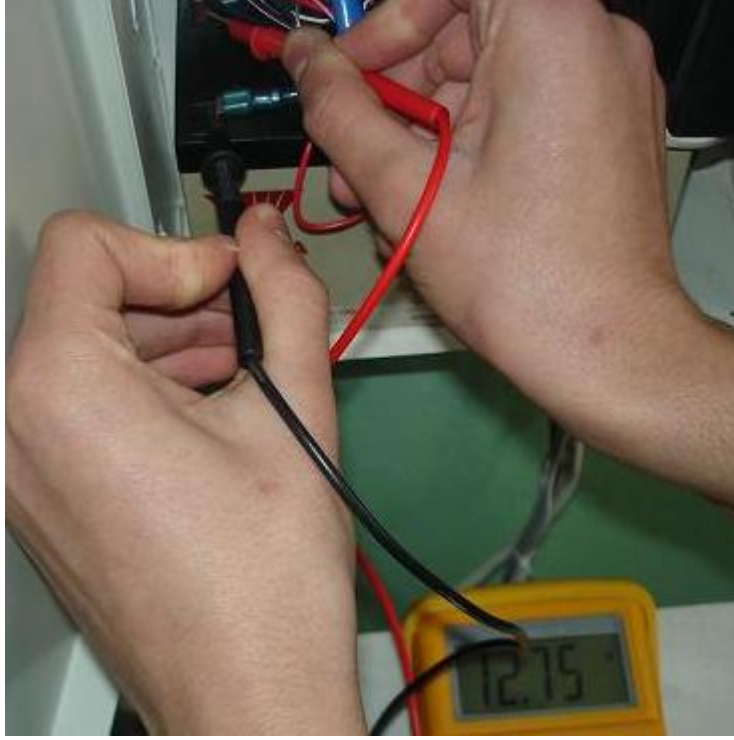
Şekil 3.4: Akü geriliminin kontrol edilmesi
