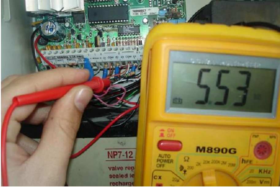
Şekil 1.17a: Soygun alarm sisteminde cihazın topraklama direncini ölçmek
