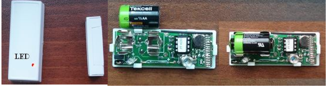
Şekil 3.2: Kablosuz kapı dedektörü ve onu besleyen pilin değiştirilmesi
