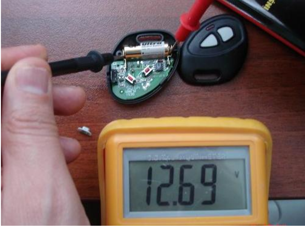
Şekil 3.3: Uzaktan kumanda pilinin geriliminin ölçülmesi
