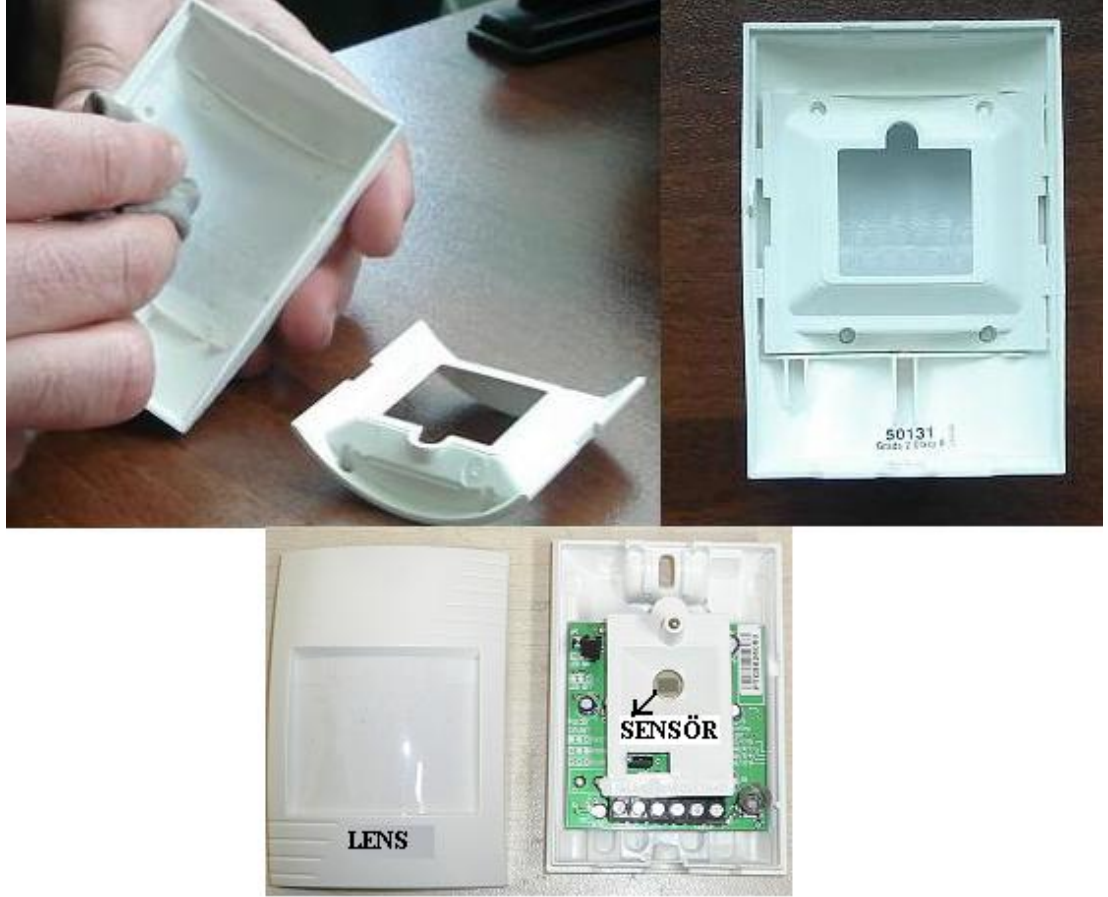
Şekil 3.1: PIR dedektörünün temizlenmesi
