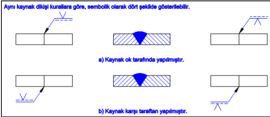
Şekil 2.10: Kaynak yerlerinin sembollerle gösterilişi-2
