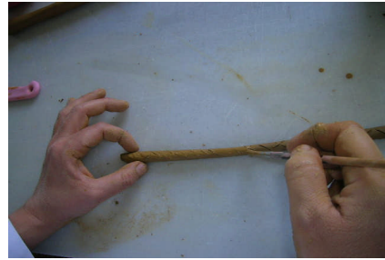
Resim 2.8: Sucukların balçık sürülmesi
