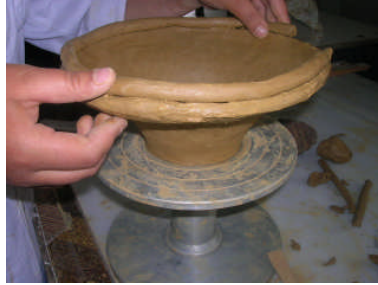
Resim 2.6: Sucukların içten sarılarak formun daraltılmaya başlanması
