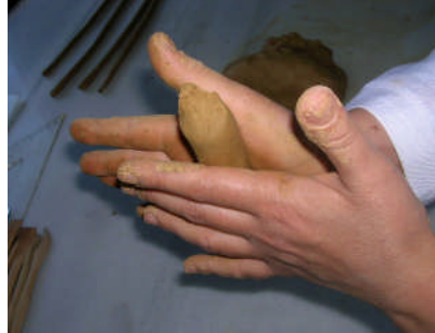
Resim 1.1: Çamurun iki el arasında inceltilmesi
