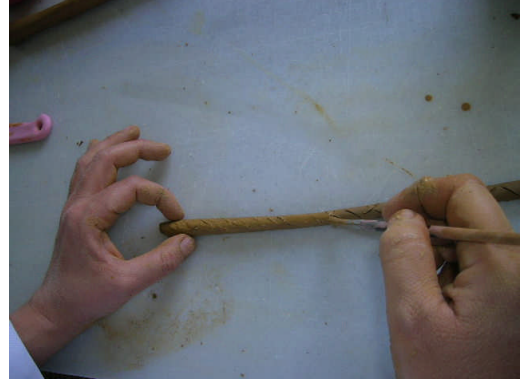
Resim 1.4: Çentikler üzerine balçık sürülmesi
