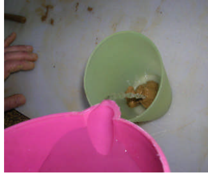
Resim 2.2: Çamurdan balçık hazırlanması
