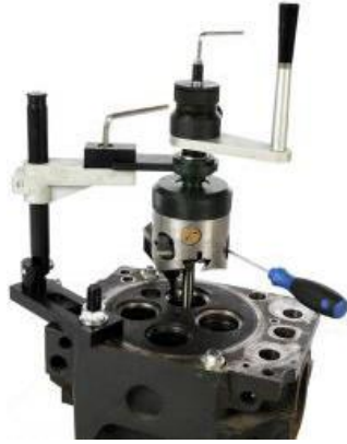
Resim 5.5: Бага yuvası açma işlemi
