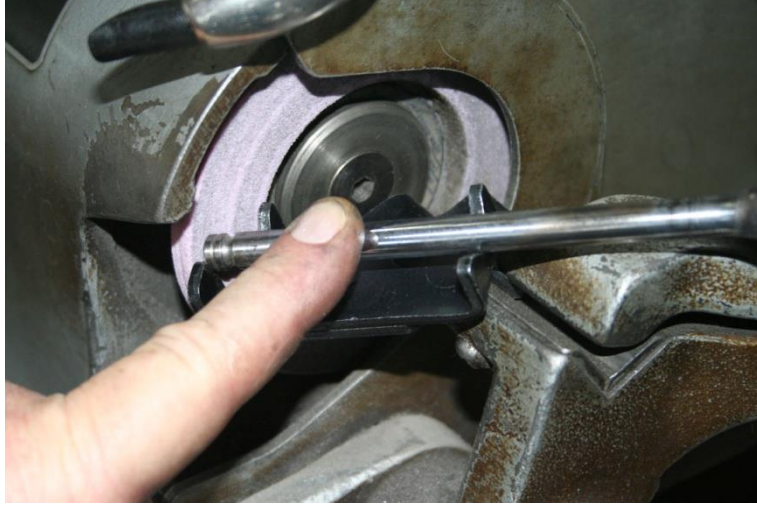
Resim 1.18: Supap sapı uç pahının kırılması
