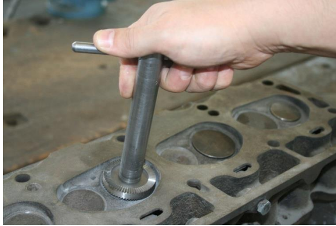
Resim 4.9: Supap yuvasının frezelenmesi
