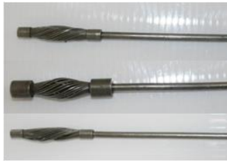
Resim 2.3:El breyizi ile temizlenmesi
