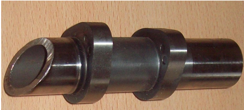
Resim 2.2: İçi boş olarak imal edilmiş kam mili
