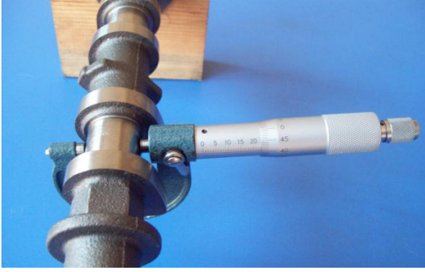
Resim 2.3: Kam muylusu ölçülmesi
