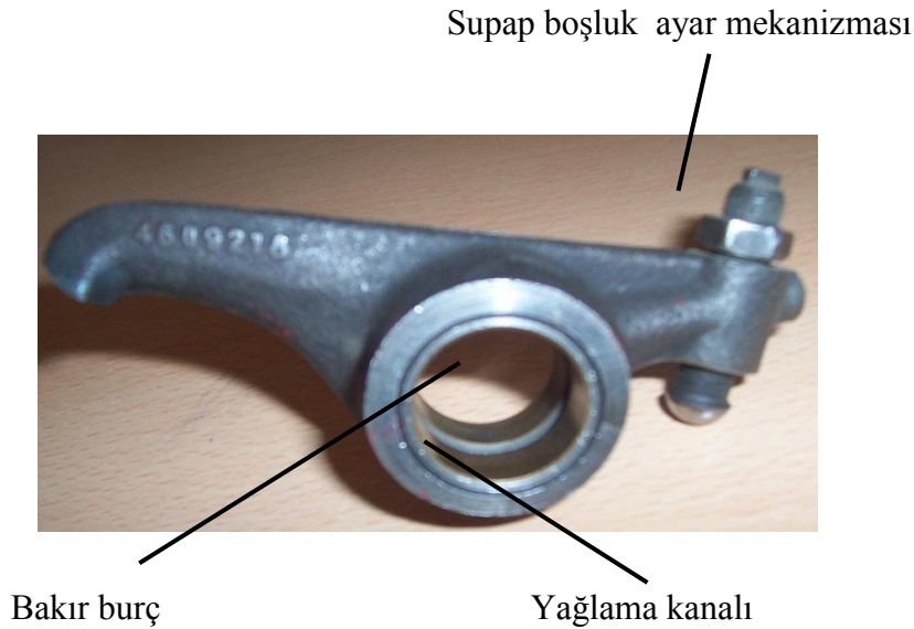
Resim 1.2: Dökme demirden yapılmış külbütör manivelası
