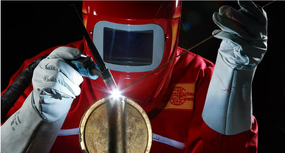
Resim 2.5: TIG kaynağının yapılışı
