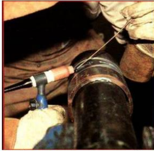
Resim 3.6: TIG boru kaynağında torcun tutuluşu
