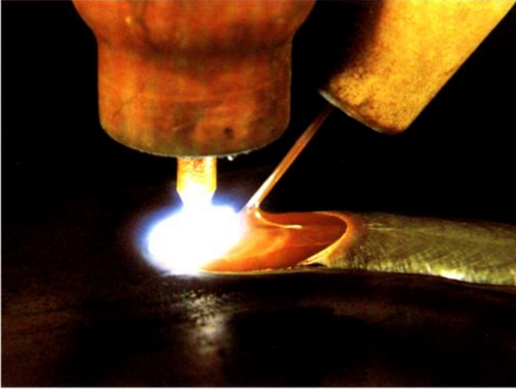
Resim 3.4: İlâve kaynak telini kaynak bölgesine otomatik olarak ileten TIG kaynak torcuyla yapılan kaynağın yakından görünüşü
