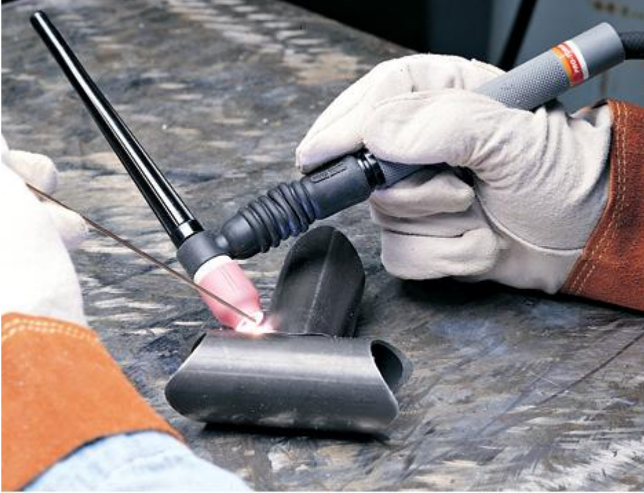
Resim 1.2. TIG kaynağıyla boruların birleştirilmesi
