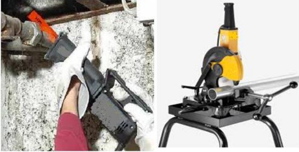
Resim 3.1: elik borunun kesilmesi
