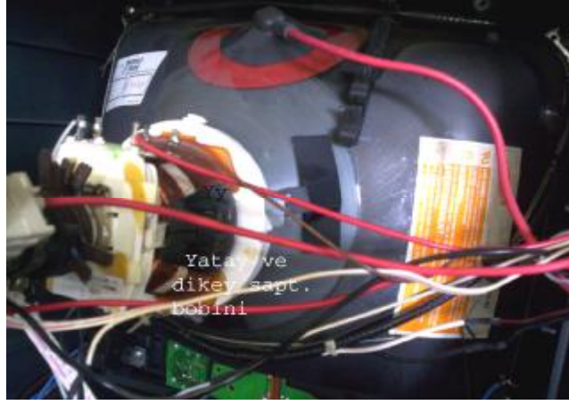
Resim 2.8: Tüp boyun kısmında saptırma bobin takımı
