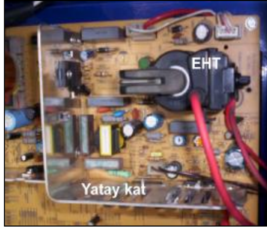
Resim 2.9: Ana şase üzerinde EHT transformatörü
