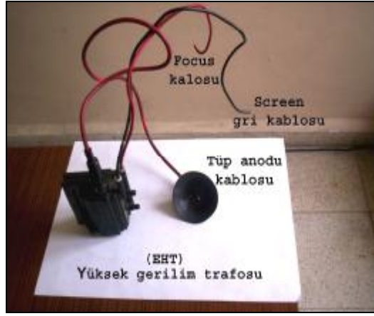
Resim. 2.10: EHT transformatörü
