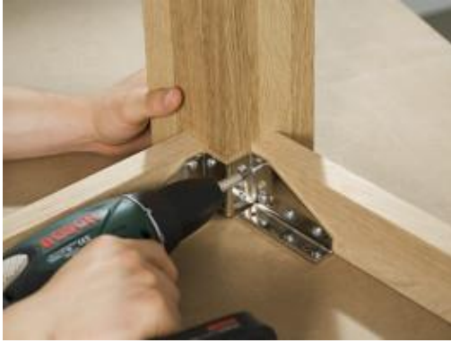
Resim 2.20: Ayak bağlantı demiriyle ayak montajı
