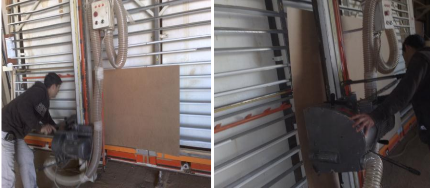
Resim 1.21: Dikey ebatlama makinesinde arkalık kesimi
