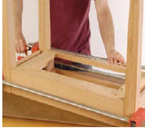
Resim 2.19: Ayak kayıt yapımı ve montajı
