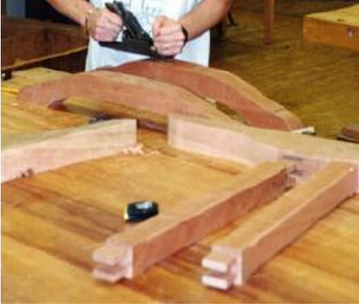
Resim 2.19: Ayak kayıt yapımı ve montajı
