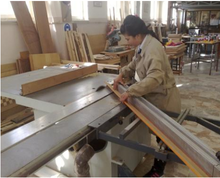
Resim 1.9: Daire testere makinesinde taç profili kesimi
