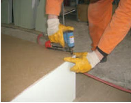
Resim 1.11: Dolap arkalığının zımba tabancasıyla montajı ve sonrasında arkalıklı dolabın görünümü
