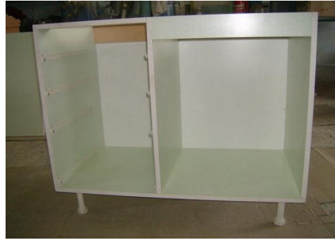
Resim 1.11: Dolap arkalığının zımba tabancasıyla montajı ve sonrasında arkalıklı dolabın görünümü
