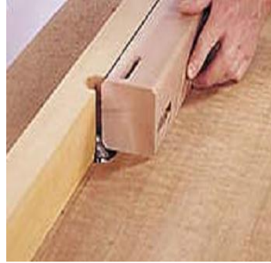
Resim 2.18: Kayıt zıvanalarını ve ayak köşelerini yuvarlatma
