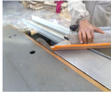
Resim 1.9: Daire testere makinesinde taç profili kesimi
