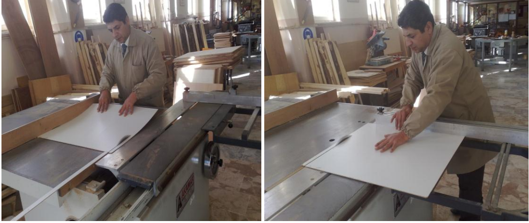
Resim 1.22: Daire testere makinesinde arkalık kesimi
