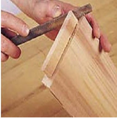
Resim 2.18: Kayıt zıvanalarını ve ayak köşelerini yuvarlatma
