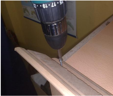
Resim 1.10: Arkalıėın ivi tabancasıyla ve Őarjlı bireyz yardımıyla vidalamak suretiyle dolaba baėlanması
