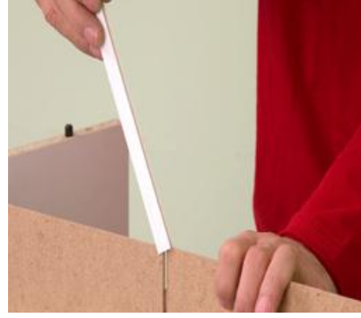
Resim 1.25: Kanal içerisinde yapılan arkalığın takılması Arkalıkların dolaba sabitlenmesinden önce zeminin terazisinde olmasını ve mutlaka dolabın köşegenleri ölçülüp gönyesinde olup olmadığı kontrol edilmelidir.
