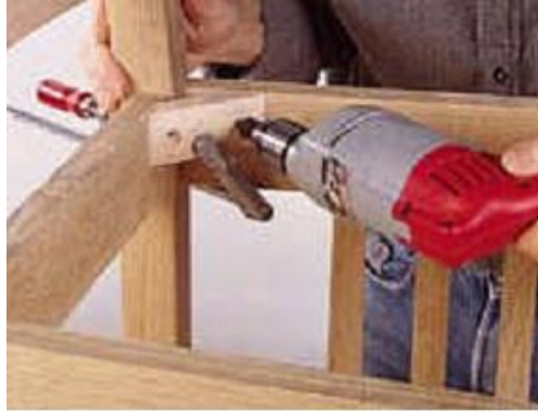
Resim 2.15: Ayak kayıt ve köşe takozu bağlantı uygulaması
