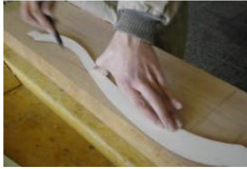
Resim 2.16: Eğmeçli ayakların şablon kullanarak kesilmesi
