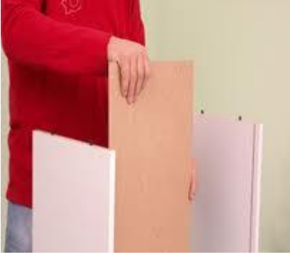
Resim 1.25: Kanal içerisinde yapılan arkalığın takılması Arkalıkların dolaba sabitlenmesinden önce zeminin terazisinde olmasını ve mutlaka dolabın köşegenleri ölçülüp gönyesinde olup olmadığı kontrol edilmelidir.
