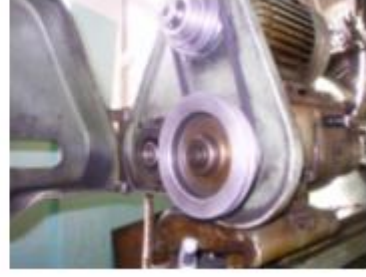
Resim 2.3: Elektrik motorundan alınan dönme hareketinin fener miline kayış ve kasnakla aktarılması
