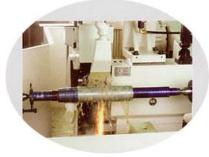
Şekil 2.6: İş parçasının firdöndü ile bağlanması ve işleme anı
