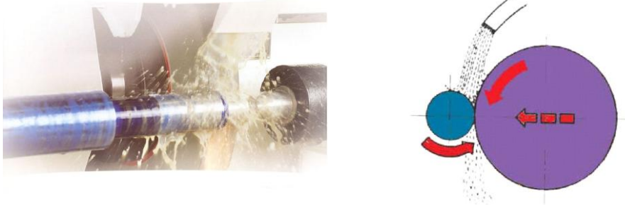
Resim 2.6: Soğutma sıvısı kullanılarak taşlama
