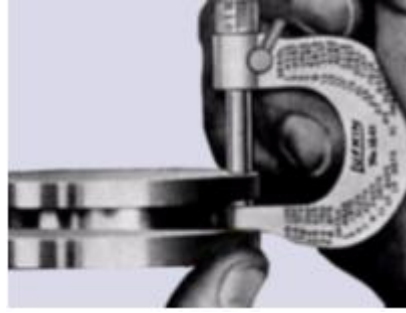
Resim 1.21: Mikrometre ile kalınlık ölçme
