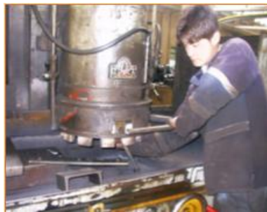
Resim 1.17: Taş parçalarının sıkılması
