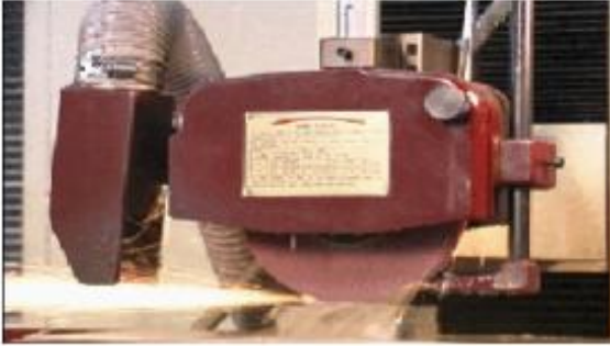
Resim 1.16: Silindirik taşla yapılan düzlem yüzey taşlama
