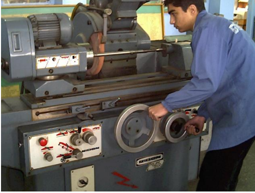
Resim 2.2: Silindirik taşlama tezgâhı ve kısımları
