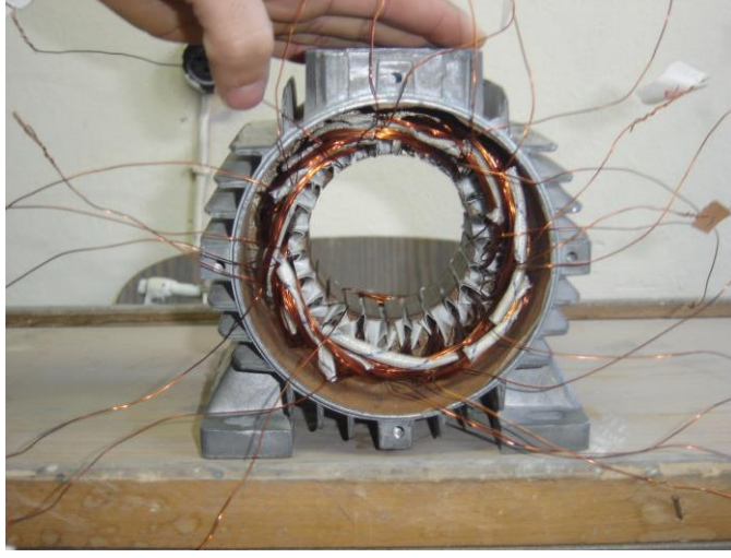
Resim 2.5: Sarımı devam eden stator ve uçları
