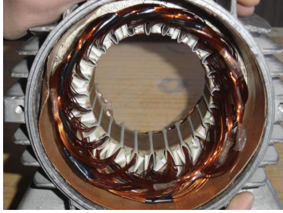
Resim 2.10: Sarımı bitmiş stator içi görünüşü
