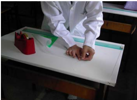
Resim 2.31: Resim kağıdının masaya tutturulması
