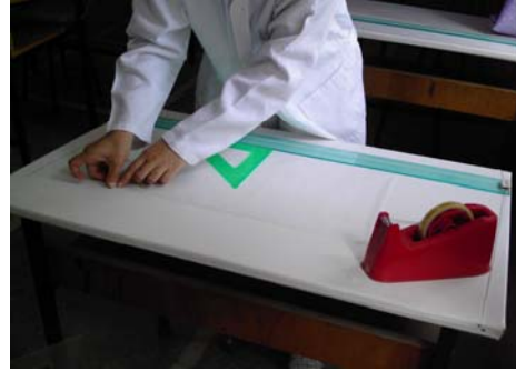
Resim 2.31: Resim kağıdının masaya tutturulması
