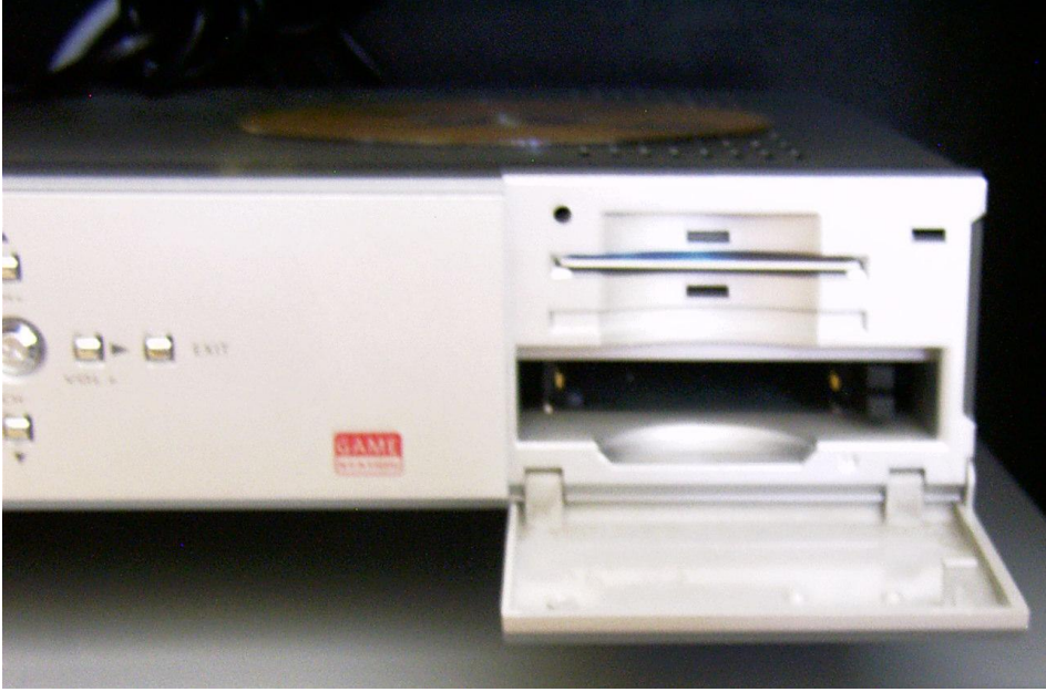
Resim 1.76: CI modül yuvası kart takılmış hâli
