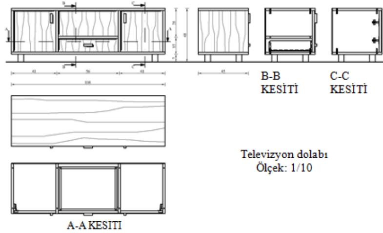
Şekil 4.6: Televizyon dolabının 1/10 ölçekli kesit resimlerinin çizilmesi
