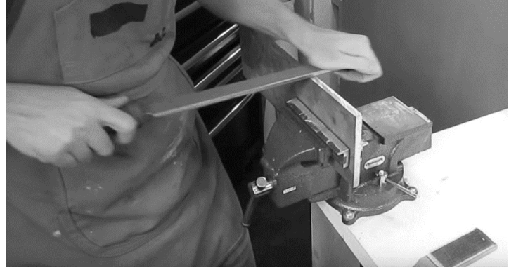
İnce iş parçasında uzun kurs kullanarak ve çapraz kaydırarak eğeleme
