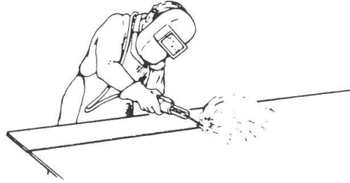
Şekil 2.8: İş parçasının elektrot kullanılarak kesilmesi
