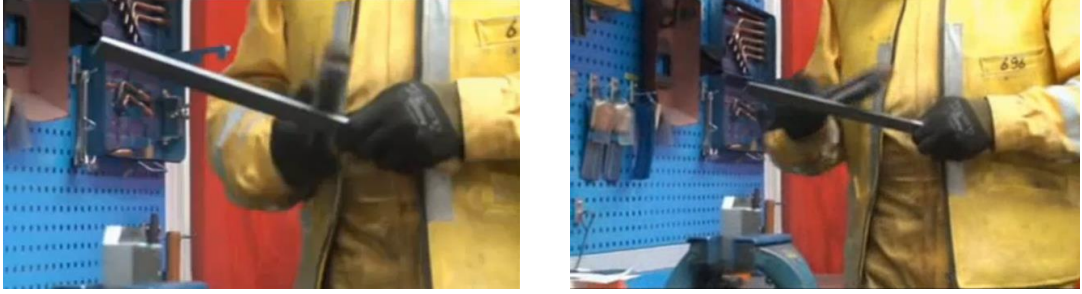
Resim 1.2: Eđe üst ve alt dişlerinin fırça ile temizlenmesi
