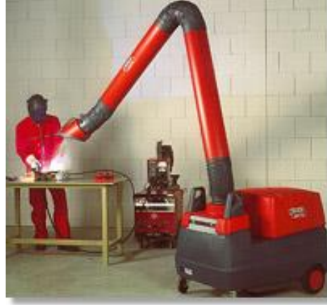
Resim 2.7: Ortamdaki pis havayı emen seyyar emeç, kaynak masası ve makinesi.
