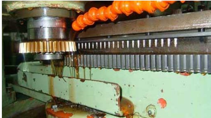
Fotoğraf 1.10: Pinyon bıçakla diş açılması
