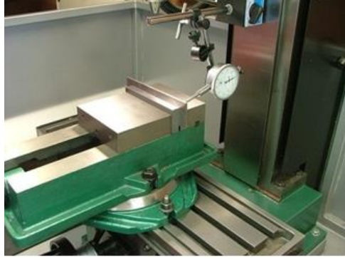
Fotoğraf 6.1: Mengene ayarında komparatörün kullanımı
