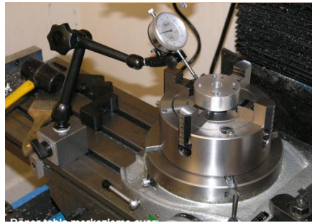
Fotoğraf 3.8 Döner tablanın komparatörle ayarlanması
