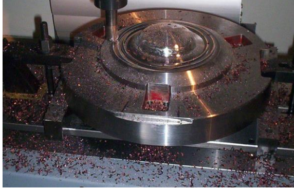
Fotoğraf 3.5: İş parçasını cıvata ve pabuçlarla bağlama
