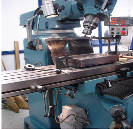
Fotoğraf 3.6: İş parçasının cıvata ve pabuçlarla bağlanması
