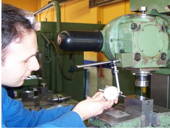
Fotoğraf 6.2: Mengenenin tablaya komparatörle paralel hâle getirilmesi
