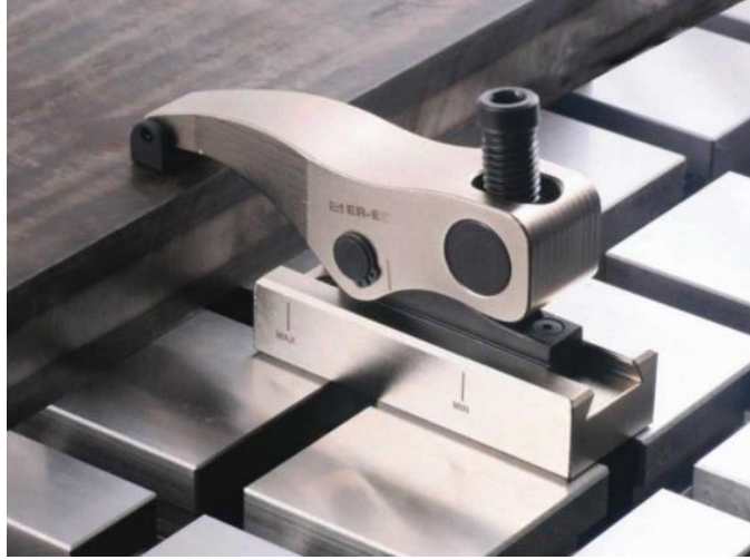
Fotoğraf 6.3: İş parçasını pabuçlar yardımıyla bağlama
