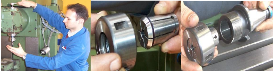
Fotoğraf 6.7: Pens tertibatının freze dik başlığına çektilmesi
