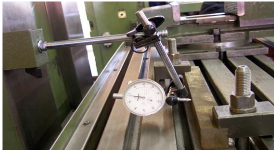
Fotoğraf 3.4: Komparatörle iş parçasının gövdeye paralel bağlama
