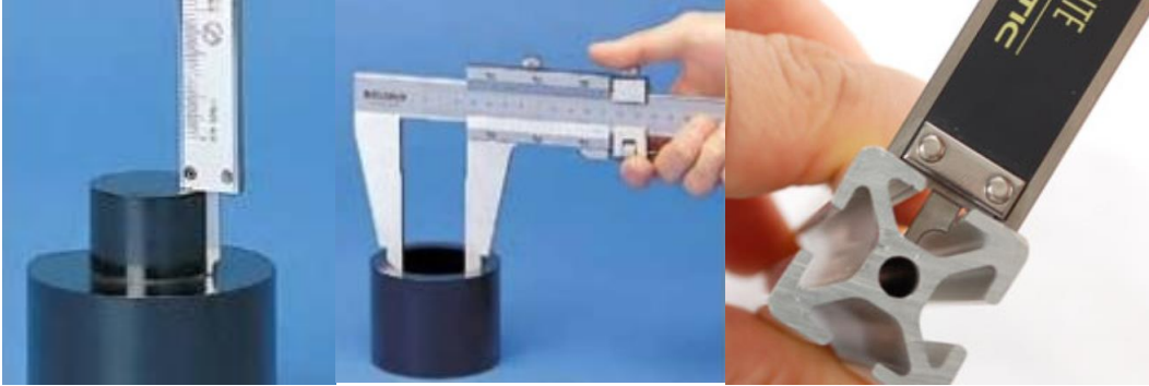
Fotoğraf 6.10: Sırasıyla kumpasla derinlik, kanal genişliği ve kanal mesafesinin ölçümü
