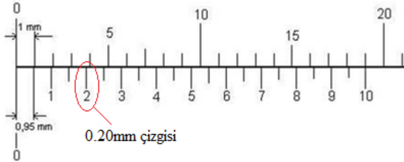
Şekil 1.25:1/30 mm hassasiyetli kumpas
