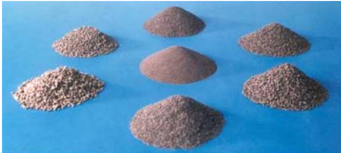
Resim 2.7: Zımparayı oluşturan değişik özellikte kum tanecikleri
