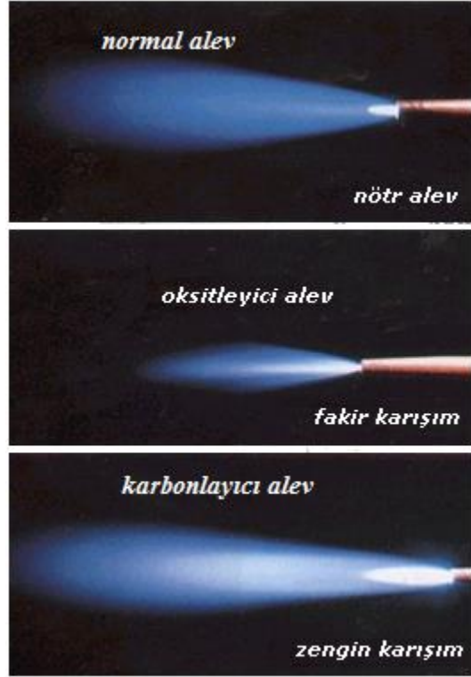
Resim 3.2: Oksi-gaz kaynağında alev yapısı
